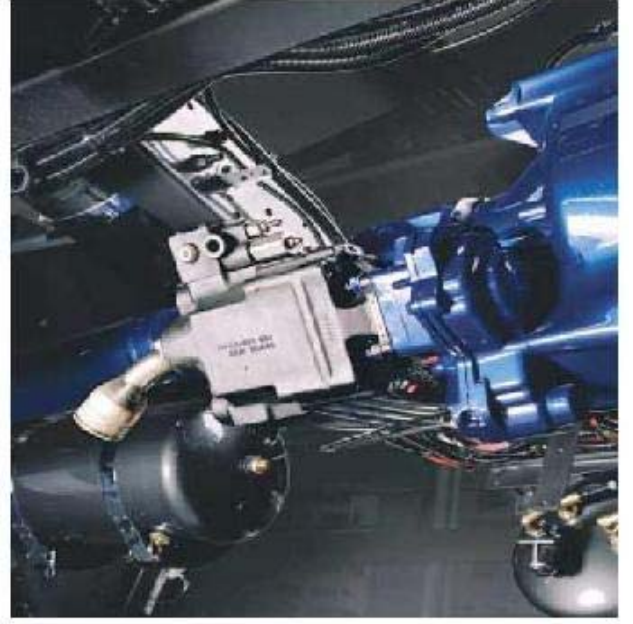
Şekil 4.6 Debriyaja bağımlı PTO. Sağ tarfata Debriyaja bağımlı şanzıman üzerindeki PTO' pompa direkt olarak bağlanmış halde.
