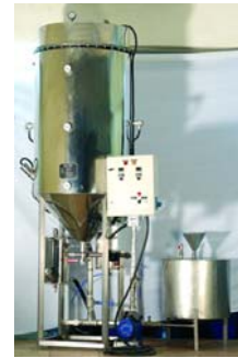
Şekil 7.6 Örnek biodiesel üretim tesisi (45).
