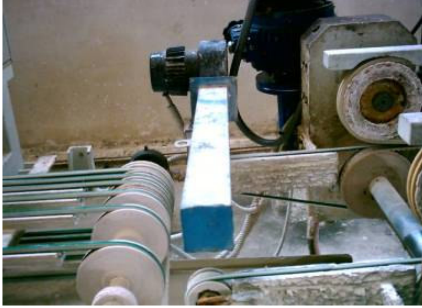
Şekil 6.10 Cam partiküllerinin tortulaşması sonucu işleme makinalarında deformasyon.
