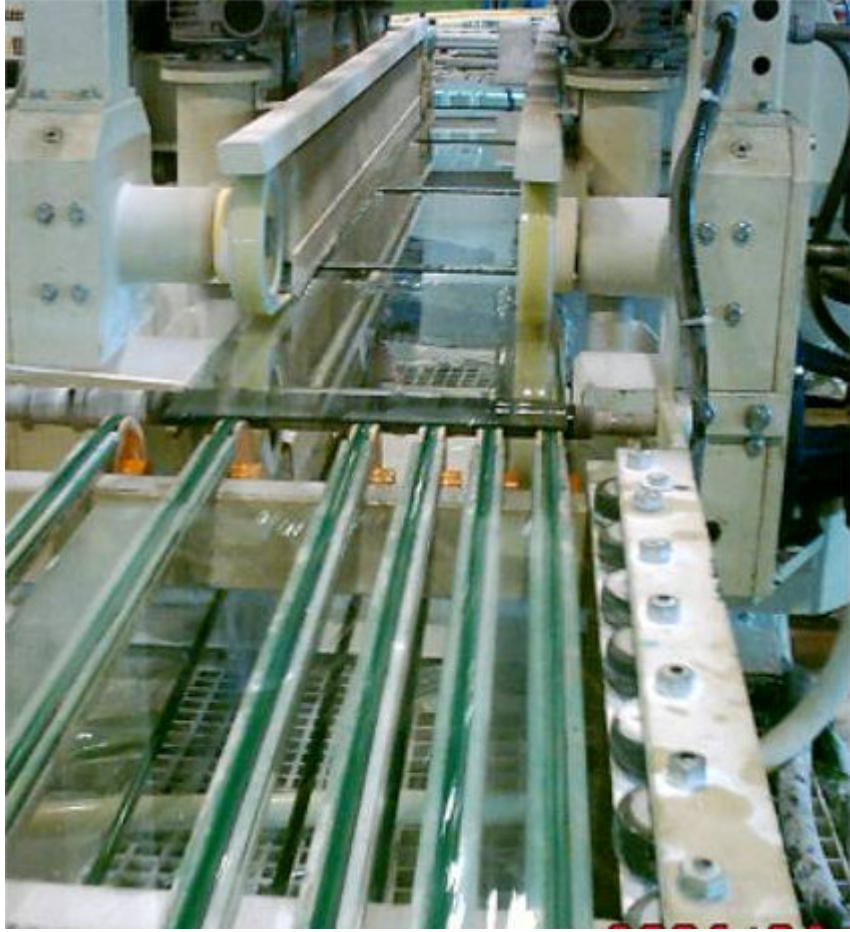
Şekil 6.14 Cam işleme makinasının proses esnasındaki görüntüsü.
