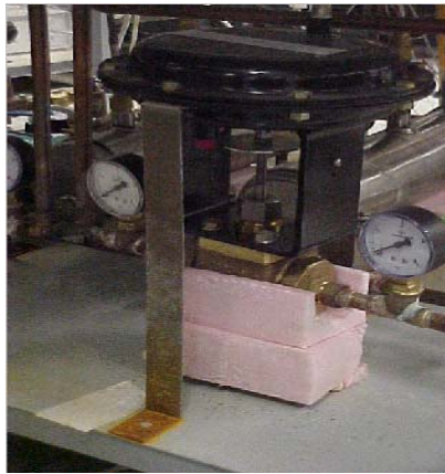
Şekil 4.4 Pnömatik kontrollü akış kontrol valfi
