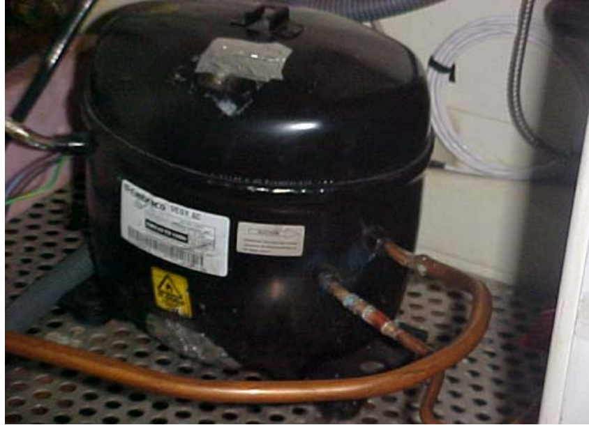
Şekil 4.6 Kılcal boru deney düzeneğinde kullanılan kompresör
