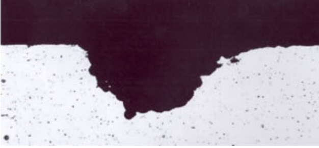
Şekil 5.14 Yüzeyi kaplanmamış alüminyumda görülen çukurcuk korozyonu.[2]
