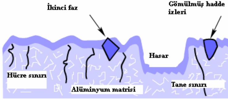
Şekil 5.6 Alüminyumun yüzeyinde bulunan olası hatalar ve kusurlar
