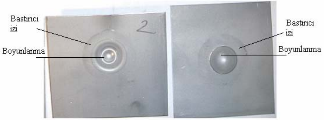
Şekil 5.9 Çökertilmiş Erichsen deney numuneleri
