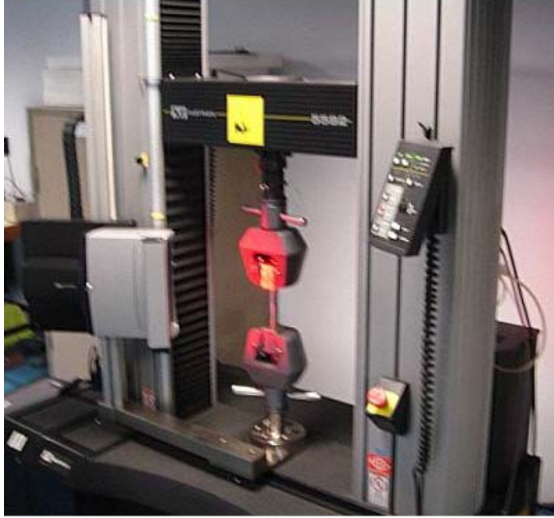
Şekil 5.4 Çekme deneylerinin uygulandığı Instron 5582 modelli test makinesi
