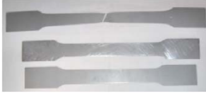
Şekil 5.7 Deneyler sırasında fotoğraflanan numuneler; kopmuş, uzamış ve çekilmemiş
