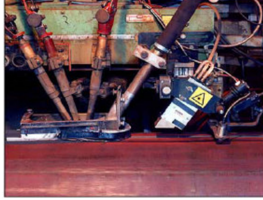
Şekil 4.10 Düz dikişli kaynaklı boruda dikişin kontrolü [13].
