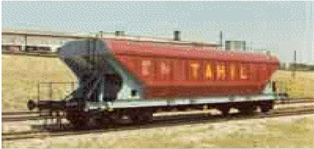
Şekil 5.3 Hububat taşıma vagonu.
