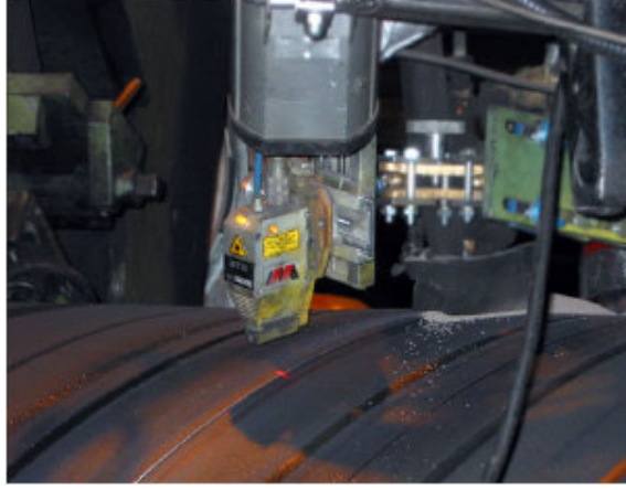
Şekil 4.7 Tozaltı kaynak yöntemiyle üretilen spiral dikişli boruda dış kaynak dikişinin lazer kontrolü [13].
