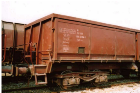
Şekil 5.1 Cevher taşıma vagonu.
