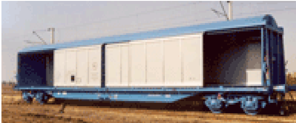
Şekil 5.4 Kayan duvarlı vagon.
