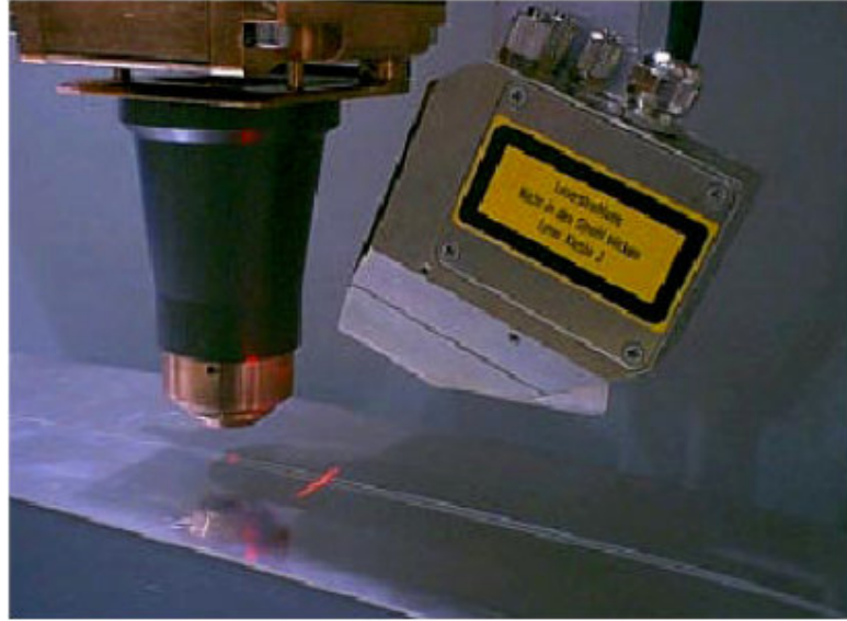
Şekil 4.13 Dikiş takip kamerasının Nd: YAG lazer kaynak kafasına kılavuzluk edişi.
