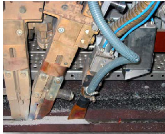
Şekil 4.11 Düz dikişli kaynaklı boruda dikiş kontrol sisteminin genel ve detay görünümü [13].
