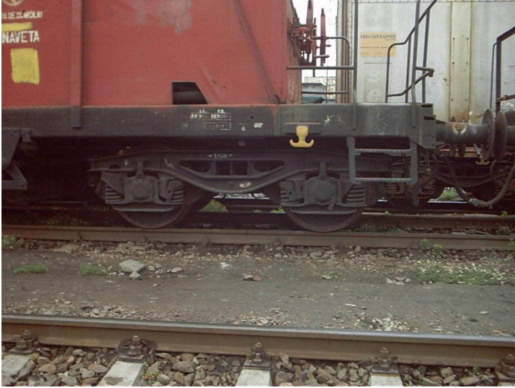
Şekil 5.8 Y25 Lsd tipi boji.
