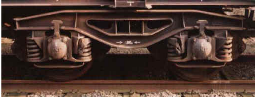
Şekil 5.11 Y 25 Lsd tipi bojinin önden görünüşü.
