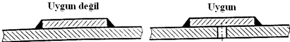
Şekil 3.39 Delik açılarak gaz sıkışması önlenmelidir (Cürgül, 2001).
