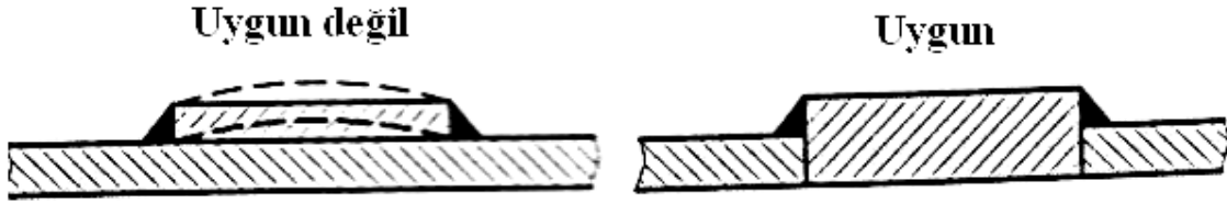
Şekil 3.38 İnce levha yerine kalın levha tercih edilmelidir (Cürgül, 2001).
