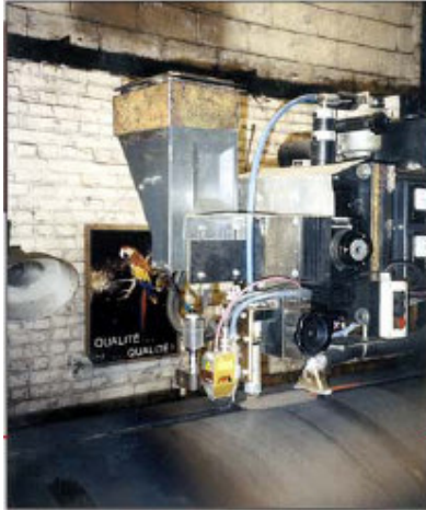
Şekil 4.11 Düz dikişli kaynaklı boruda dikiş kontrol sisteminin genel ve detay görünümü [13].
