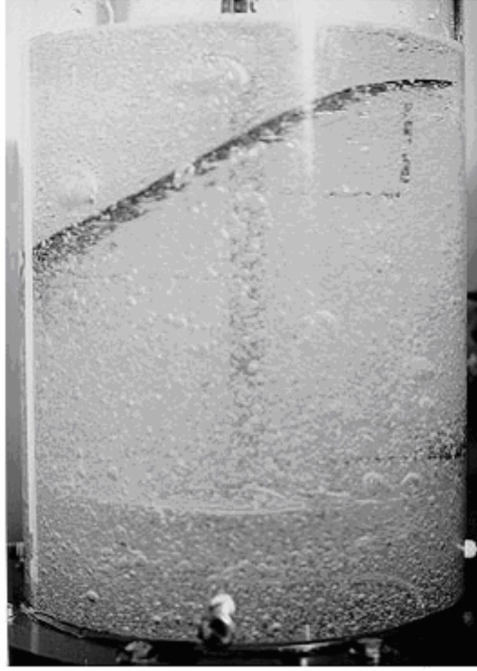
Şekil 5.25 HR-ST tipi karıştırıcıda mısır şurubu solüsyonu kullanarak ( 0.5 \text{ Pa}\cdot\text{s} ), Q=0.5 \text{ vvm} N_{ST}=10 \text{ s}^{-1} ( Fr = 0.71 ve Fl = 0,02 ), ve N_{ST} / N_{HR}=10 olduğunda gaz dispersiyonu
