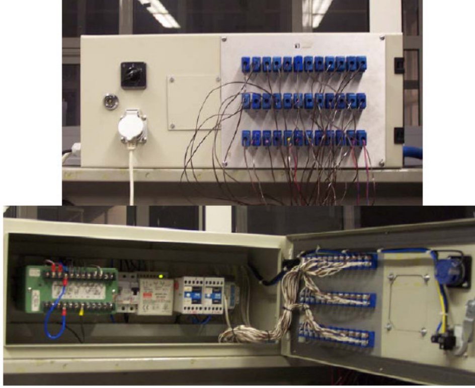
Şekil 4.4 Veri toplama ünitesi (Dış görünüş üstte, iç görünüş altta)
