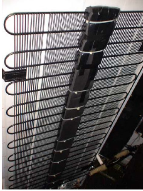
Şekil 5.2 Yoğuşturucunun kanatları kapatılmış durumda EDD’de performans deneyi öncesi görünümü
