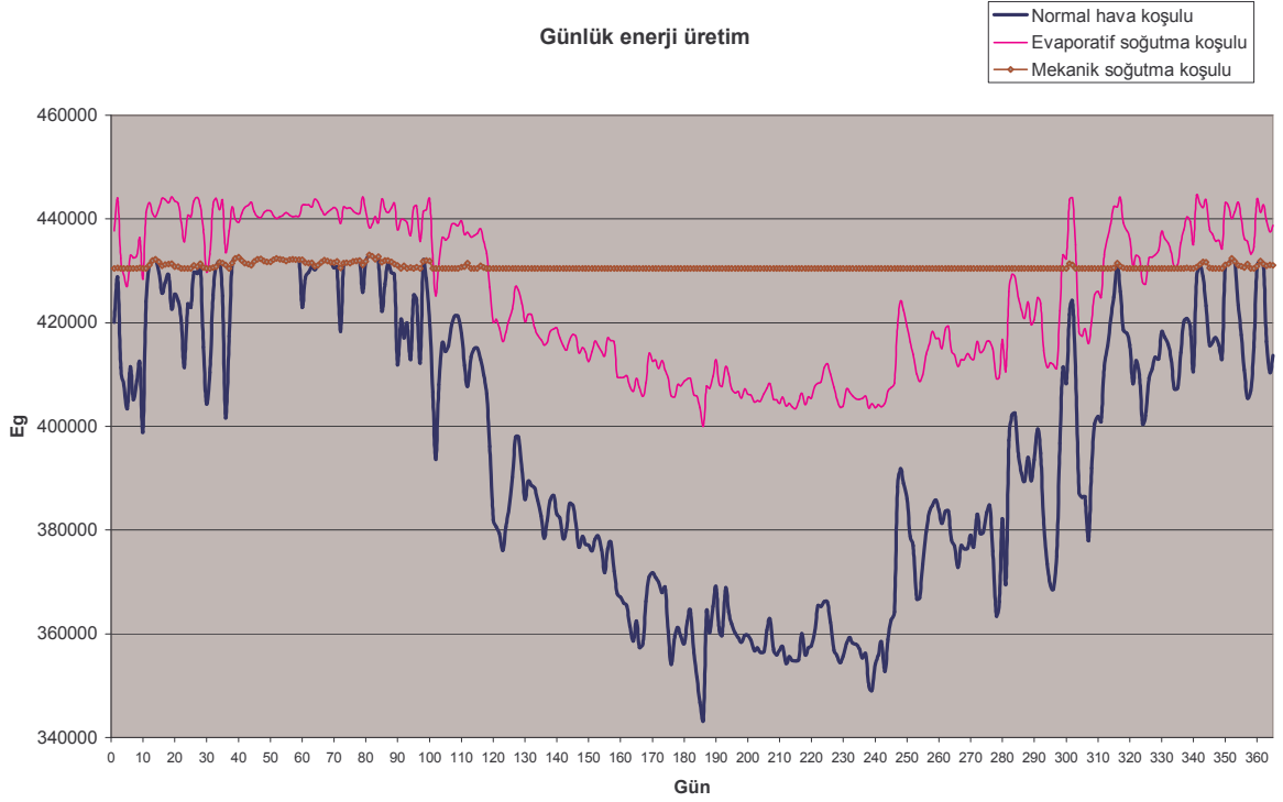
Şekil 4.10 İstanbul normal hava koşulunda ,evaporatif ve mekanik soğutma yapıldığı hallerdeki enerji üretim diyagramı
