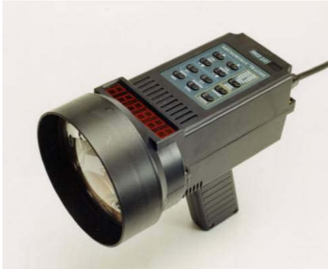
Şekil 5.18 Fan devrinin belirlenmesi amacıyla kullanılan stroboskop
