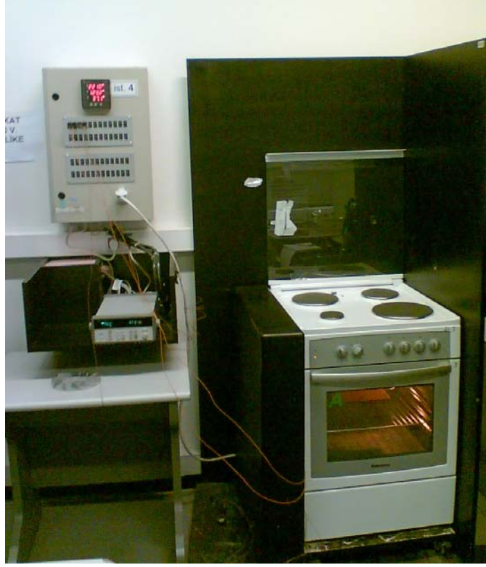
Şekil 4.2 Enerji tüketimi deney düzeneğinin görünüşü
