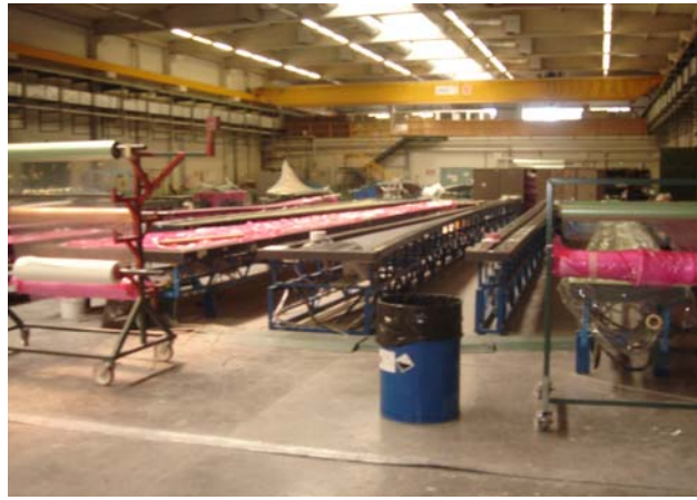
Şekil 5.12 Yarı Kalıba Dizilmiş Fiber Malzemelerin Poşetle Kaplanması (Aero A.Ş., İzmir)
