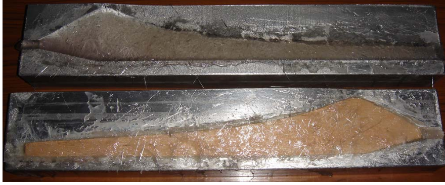
Şekil 6.34 Her İki Model Yarısının Etüv’de Kürülenmesinden Önce Laboratuar Koşullarında Bekletilmesi
