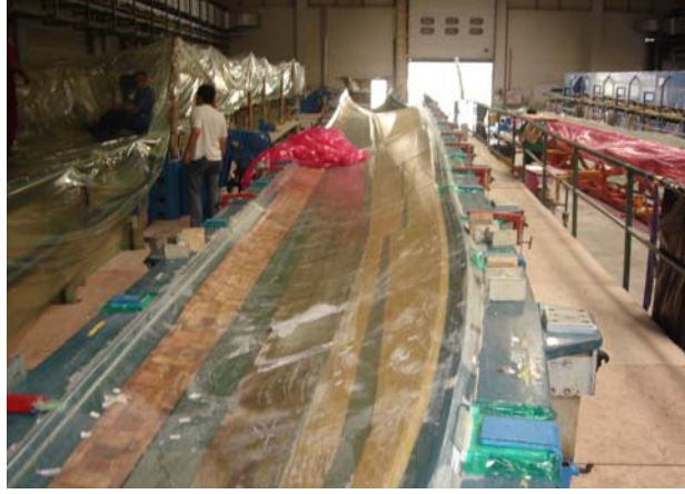
Şekil 5.13 Yarı Kalıp Kapama Düzeneginde Kapama İşlemi Öncesi Beklerken (Aero A.Ş., İzmir)
