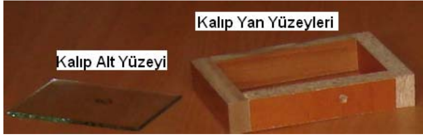
Şekil 6.4 Kompozit Malzemeler Üretilirken Kullanılan Kalıp
