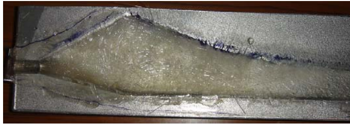
Şekil 6.33 Cam Fiber Keçeye Sürülen Polyester Reçinenin Jelleşmesi
