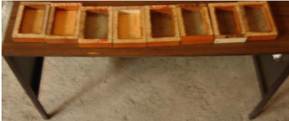
Şekil 6.5 Kalıp İçerisinde Sertleşmekte Olan Kompozit Malzemeler
