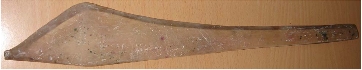
Şekil 6.35 Profil Kiriş Uzunluğu 400 mm Olacak Şekilde Üretilen Kanat Modeli
