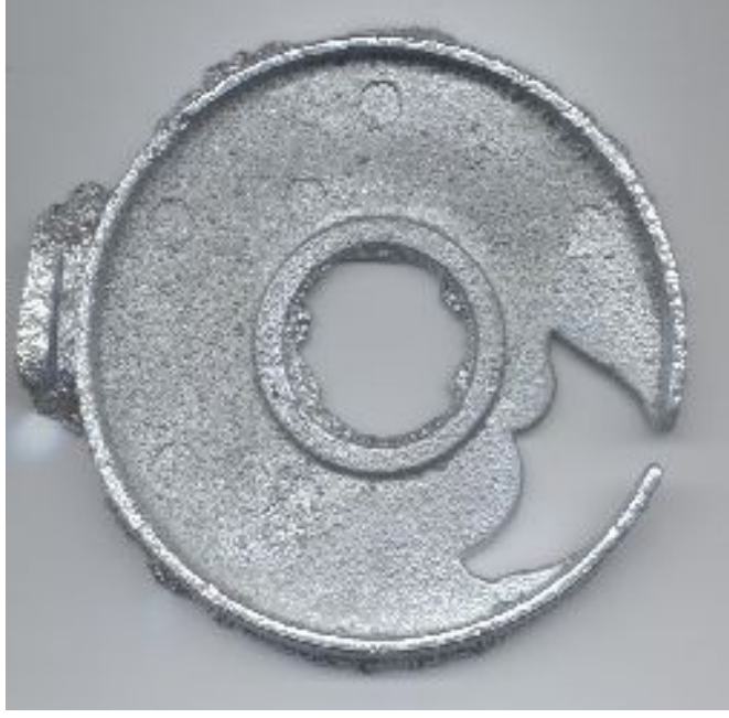
Şekil 5.10 Uygun olmayan yolluk tasarımı sonucu ürünün tam elde edilememesi
