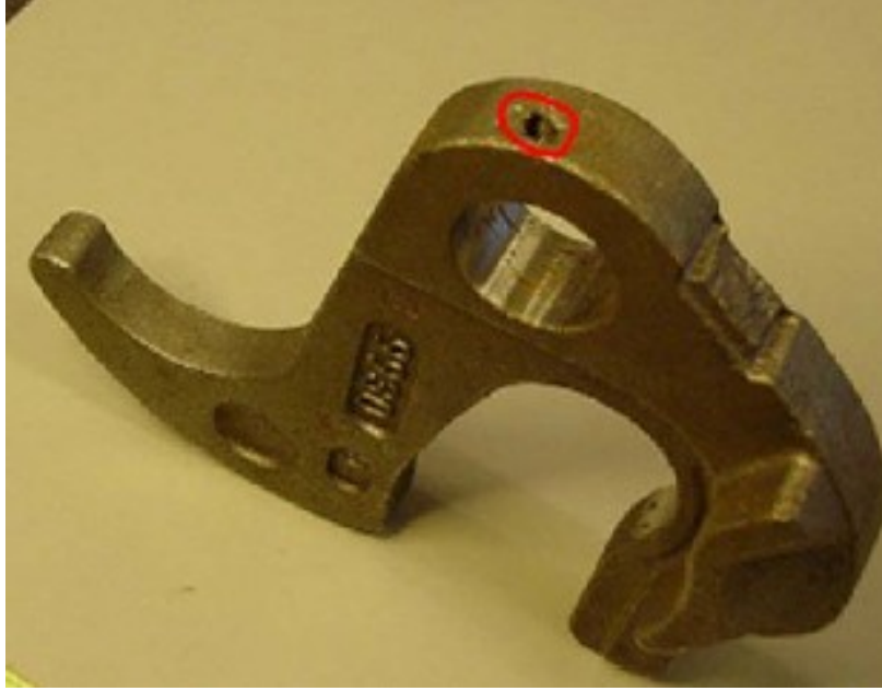
Şekil 5.12 Yanlış konumlandırma sonucu üründe yaşanan havalandırma sorunu
