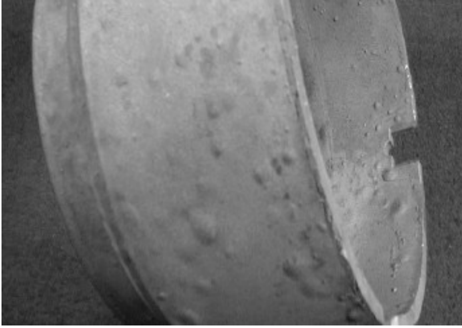
Şekil 5.11 Bölgesel soğutma sonucu oluşan porozite ve yüzeysel hatalar
