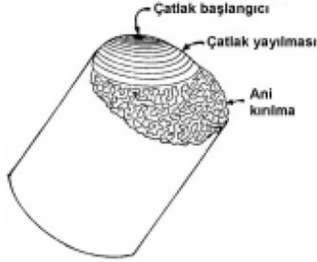
Şekil 1.2. Çatlak başlangıç, yayılma ve ani kırılma bölgelerini gösteren çelik bir mildeki yorulma kırığı yüzeyinin resmi (8)
