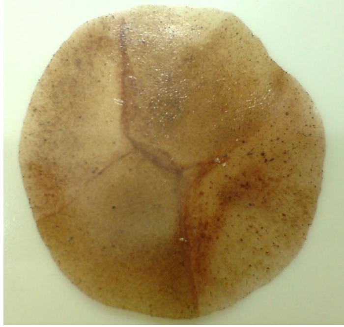
Şekil 5.11 %40 LM %60 YYPE KM 'nin film hale getirilmiş görüntüsü (6x büyültme)
