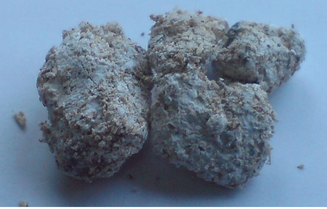
Şekil 5.5 YYPE'in Ksilen ile çözdürme yöntemi ile üretilen kompozit ürünün görüntüsü
