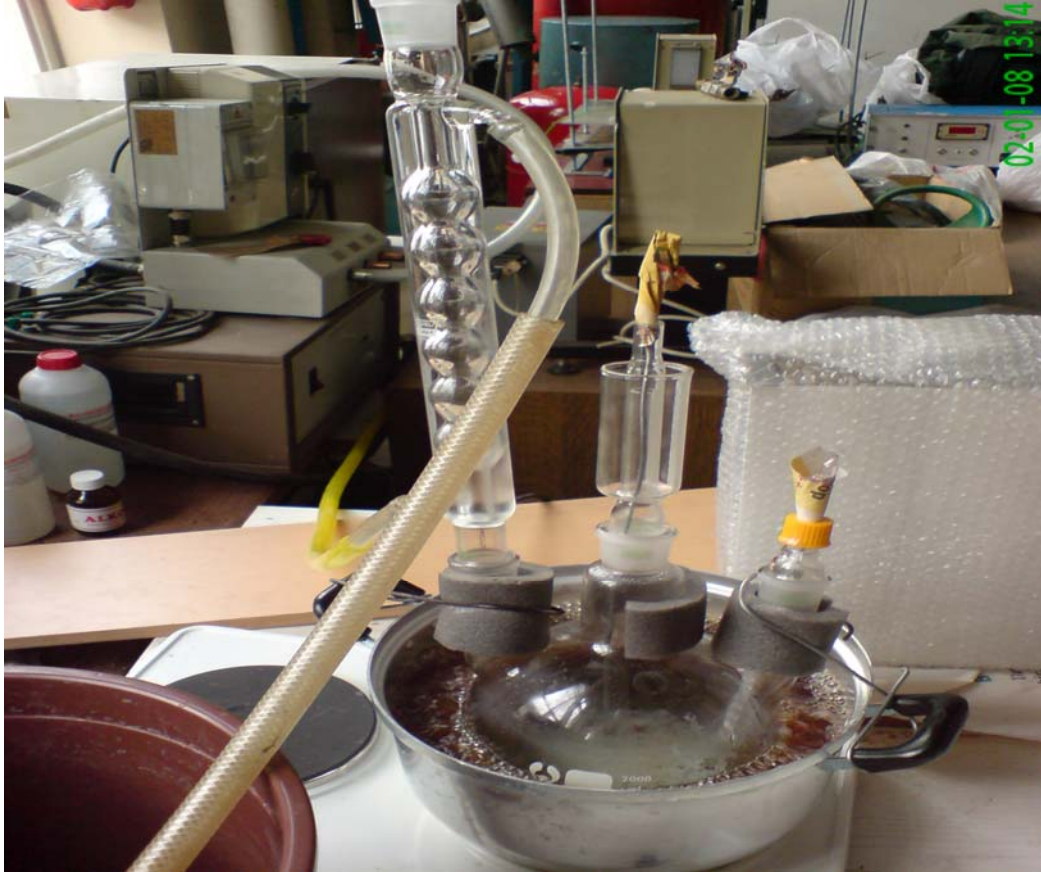
Şekil 5.6 YYPE'nin Ksilen ile çözdürme deneğinin uygulama resmi
