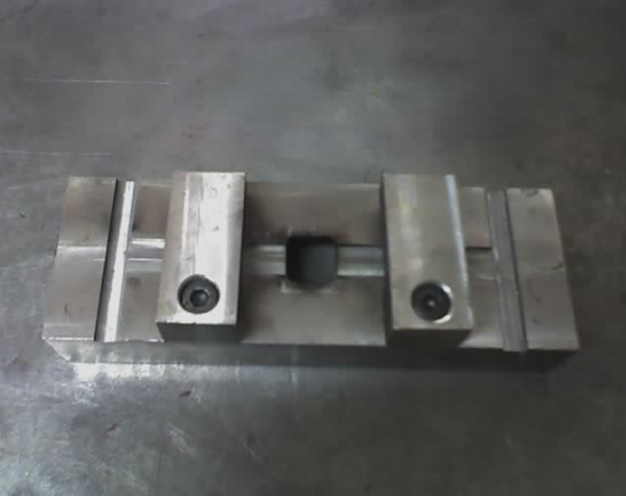
Şekil 9.4 Distorsiyonları önlemek için geliştirilen aparat
