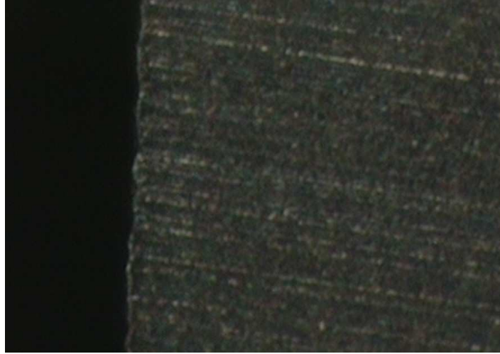
Şekil 6.14. Kesici takım 4L'nin üzerindeki "X tipi kaplamanın" 1000 kez büyültülmüş görünümü (Şekil 6.13. b'nin daha yakından görünümü)
