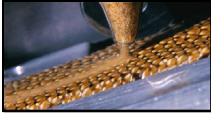
Şekil 2.11. öl balığı derisi üzerinde gerçekleştirilen dinamik sürtünme katsayısı deneyleri, (öl kumu akışı, 20°-21°) (Baumgartner vd., 2007; [1])
