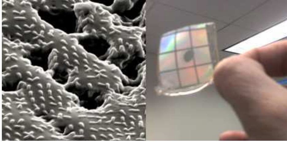
Şekil 2.9. Geckolardan esinlenilerek MIT araştırmacıları tarafından geliştirilmiş oldukça esnek, biyolojik olarak ayrışabilen bandın büyültülmüş ve normal boyuttaki görünümü [4]
