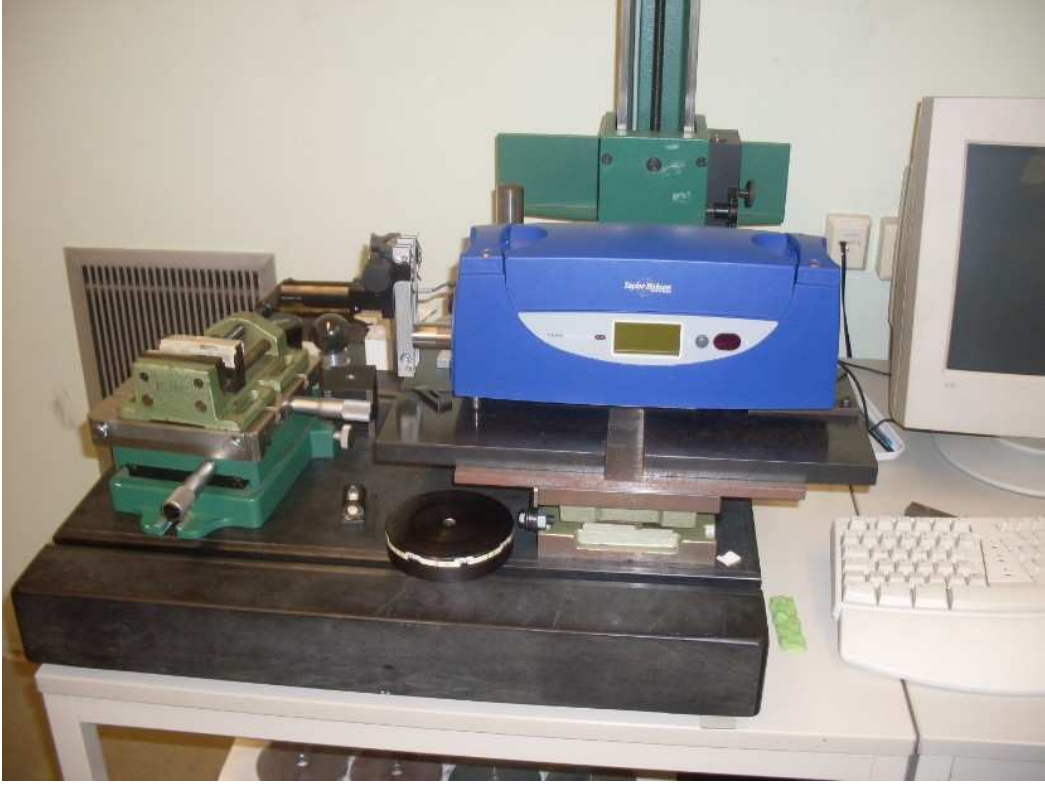
Şekil 5.12. Yüzeý incelemelerinin gerekleřtirildiđi Viyana Teknik niversitesi Hassas lm Odası ve Nanoteknoloji Laboratuvarı'nda bulunan Taylor Hobson Form Talysurf Intra cihazı
