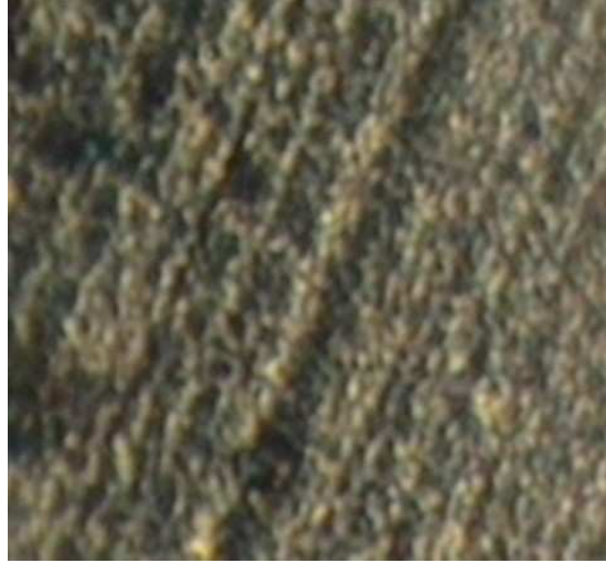
Şekil 6.3. Kesici takım 1L'nin üzerindeki elmas kaplamasının 1000 kez büyütülmüş görünümü
