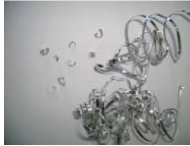
Şekil 7.28 Al7175 kaba tornalama çevrimi ile elde edilen talaşlar ( a=3 mm, V_c=140 m/dak , f=0,20-0,30 mm/dev R_a=1.503 \mu m)
