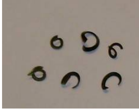
Şekil 7.21 AISI4140 malzemenin hassas tornalanmasında kırılan talaşlar ( a=1 mm, V_c= 320 m/dak , f= 0,38 mm/dev)
