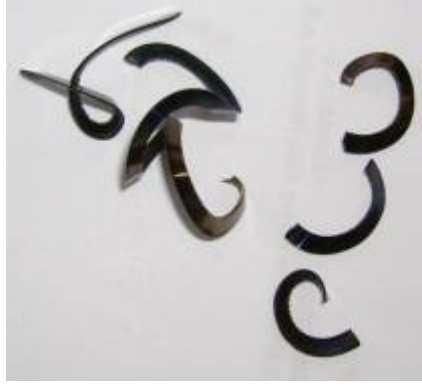
Şekil 7.16 AISI4140 malzemenin kaba tornalanmasında kırılan talaşlar ( a=3 mm, V_c= 120 m/dak , f= 0,40 mm/dev)
