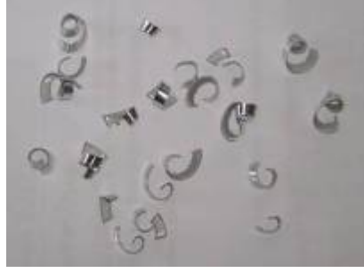
Şekil 7.8 Al7175 malzemenin kaba talaş kaldırılmasında kırılan talaşlar ( a=3 mm, V_c= 140 m/dak , f= 0,30 mm/dev)
