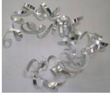
Şekil 7.7 Al7175 malzemede kaba talaş kaldırma işlemi ile elde edilen sürekli talaş ( a=3 mm, V_c= 140 m/dak , f= 0,25 mm/dev)
