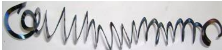
Şekil 7.15 AISI4140 malzemede kaba talaş kaldırma işlemi ile elde edilen sürekli talaş ( a=3 mm, V_c= 120 m/dak , f= 0,35 mm/dev)
