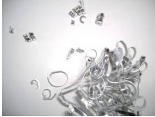
Şekil 7.26 Al7175 kaba tornalama çevrimi ile elde edilen talaşlar ( a=3 mm, V_c=140 m/dak , f=0,20-0,30 mm/dev R_a=1.491 \mu\text{m} )
