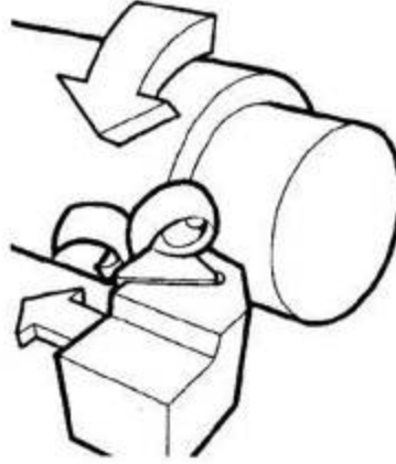
Şekil 4.4 Talaş mekanizmasının sistematik gösterimi (Çakır, 2000)
