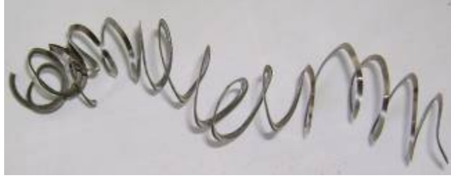
Şekil 7.19 AISI4140 malzemede kaba talaş kaldırma işlemi ile elde edilen sürekli talaş ( a=1 mm, V_c=320 m/dak , f=0,30 mm/dev)
