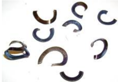
Şekil 7.17 AISI4140 malzemenin kaba tornalanmasında kırılan talaşlar ( a=3 mm, V_c= 120 m/dak , f= 0,45 mm/dev)
