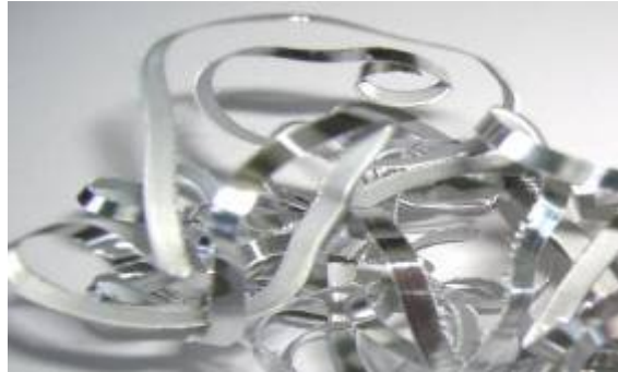
Şekil 7.6 Al7175 malzemede kaba talaş kaldırma işlemi ile elde edilen sürekli talaş ( a=3 mm, V_c= 140 m/dak , f= 0,20 mm/dev)
