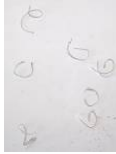
Şekil 7.12 Al7175 malzemenin hassas tornalanmasında kırılan talaşlar ( a=0,1 mm, V_c= 300 m/dak , f= 0,32 mm/dev)
