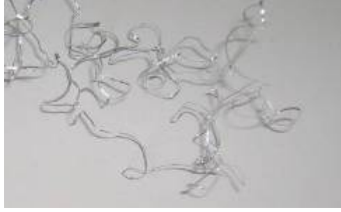
Şekil 7.11 Al7175 malzemende hassas tornalanma işlemi ile elde edilen sürekli talaş ( a=0,1 mm, V_c= 300 m/dak , f= 0,28 mm/dev)
