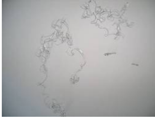
Şekil 7.30 Al7175 hassas tornalama çevrimi ile elde edilen talaşlar ( a=0,10 mm, V_c= 300 m/dak , f= 0,24-0,32 mm/dev R_a= 1.096 \mu\text{m} )
