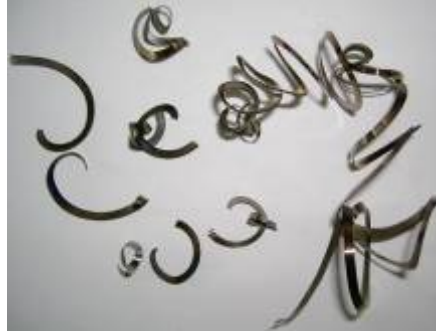
Şekil 7.22 AISI4140 kaba tornalama çevrimi ile elde edilen talaşlar ( a=3 mm, V_c= 120 m/dak , f= 0,30-0,40 mm/dev R_a= 1.557 \mu\text{m} )
