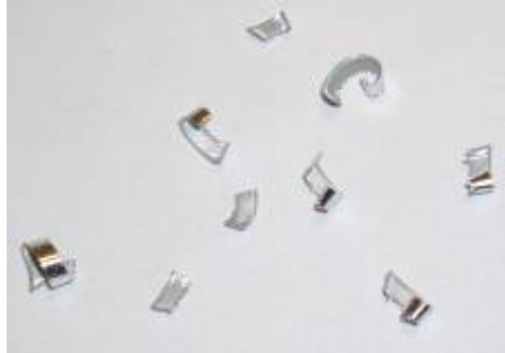
Şekil 7.9 Al7175 malzemenin kaba talaş kaldırılmasında kırılan talaşlar ( a=3 mm, V_c= 140 m/dak , f= 0,35 mm/dev)
