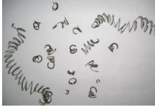
Şekil 7.24 AISI4140 hassas tornalama çevrimi ile elde edilen talaşlar ( a=1 mm, V_c= 320 m/dak , f= 0,26-0,34 mm/dev R_a= 1.341 \mu m)
