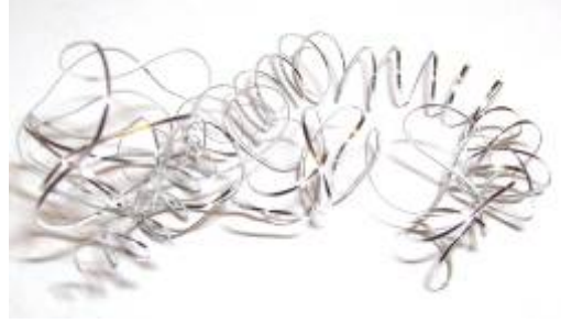
Şekil 7.10 Al7175 malzemende hassas tornalanma işlemi ile elde edilen sürekli talaş ( a=0,1 mm, V_c= 300 m/dak , f= 0,24 mm/dev)
