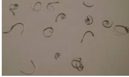
Şekil 7.13 Al7175 malzemenin hassas tornalanmasında kırılan talaşlar ( a=0,1 mm, V_c= 300 m/dak , f= 0,36 mm/dev)
