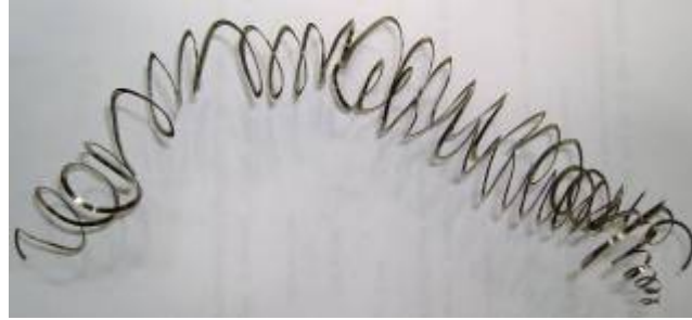
Şekil 7.18 AISI4140 malzemede kaba talaş kaldırma işlemi ile elde edilen sürekli talaş ( a=1 mm, V_c= 320 m/dak , f= 0,26 mm/dev)
