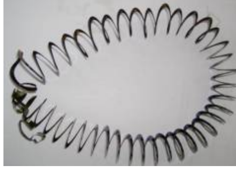
Şekil 7.14 AISI4140 malzemede kaba talaş kaldırma işlemi ile elde edilen sürekli talaş ( a=3 mm, V_c= 120 m/dak , f= 0,30 mm/dev)
