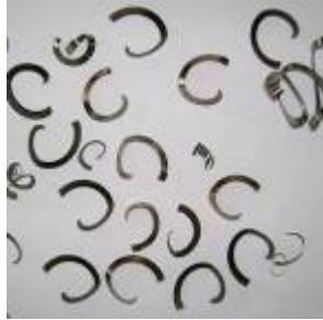
Şekil 7.20 AISI4140 malzemenin hassas tornalanmasında kırılan talaşlar ( a=1 mm, V_c=320 m/dak , f=0,34 mm/dev)
