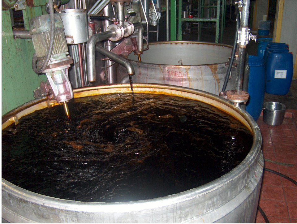
Şekil 2.1. Fiksaj kabinine girmeden önce boyanın karıştırılma anı
