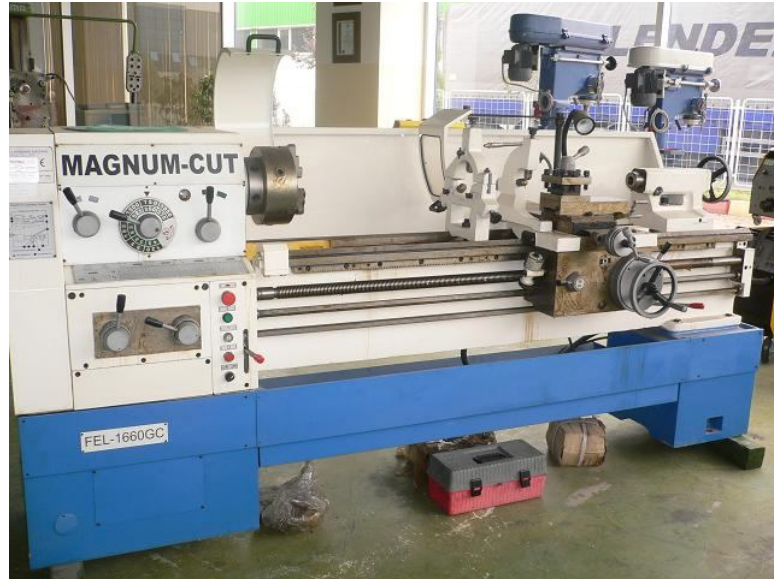
Şekil 4.7 Torna tezgahı hareketli koruyucu ile aydınlatma elemanı
