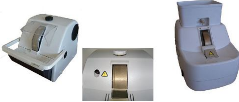
Şekil 4.28 Kuyumculuk sektöründe kullanılan el taşları koruyucuları ve su haznesi
