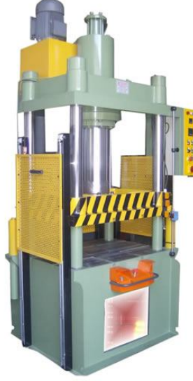
Şekil 4.8 Pres ve üzerindeki koruyucular ve caydırıcı işaretler
