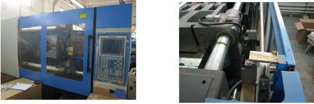
Şekil 4.76 Plastik enjeksiyon makinesindeki yarı-mekanik düzenek
