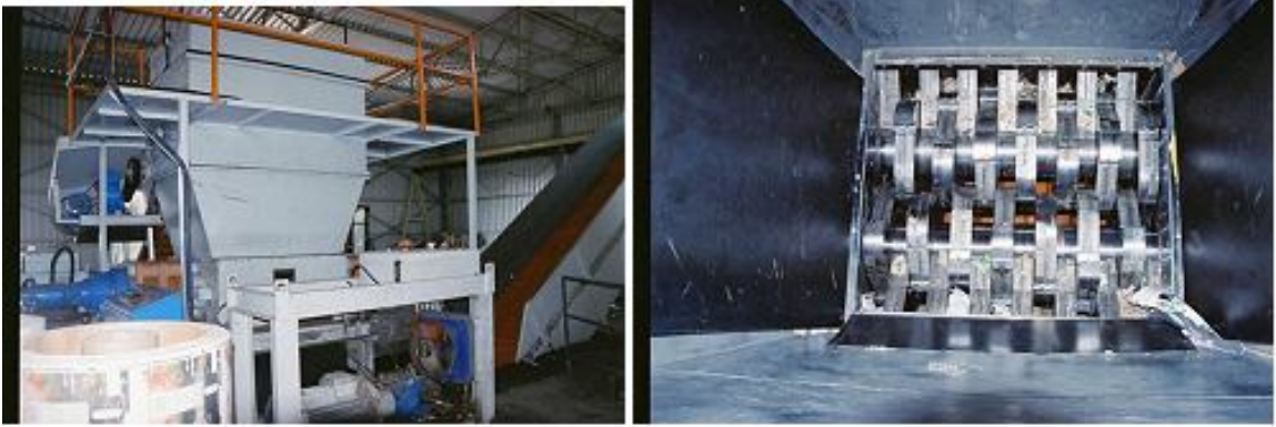
Şekil 4.32 Taraklı kırma makineleri ve koruyucu besleme hunisi
