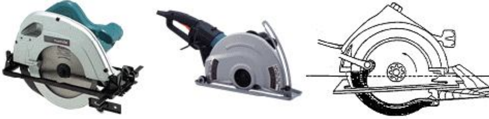
Şekil 3.8 Testerelerde kullanılan kendiliğinden kapanan bir koruyucu
