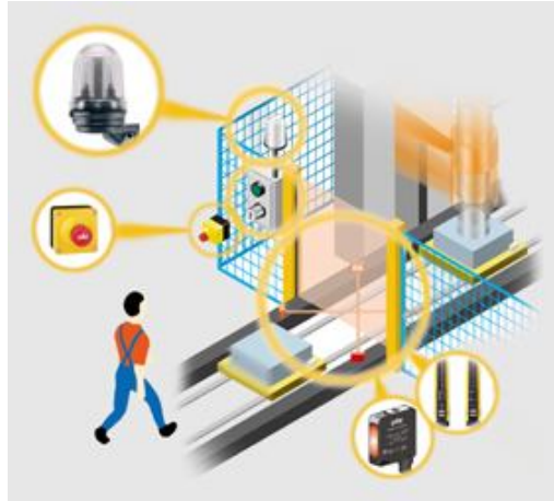
Şekil 5.9 Konveyörlerdeki muting sistemi
