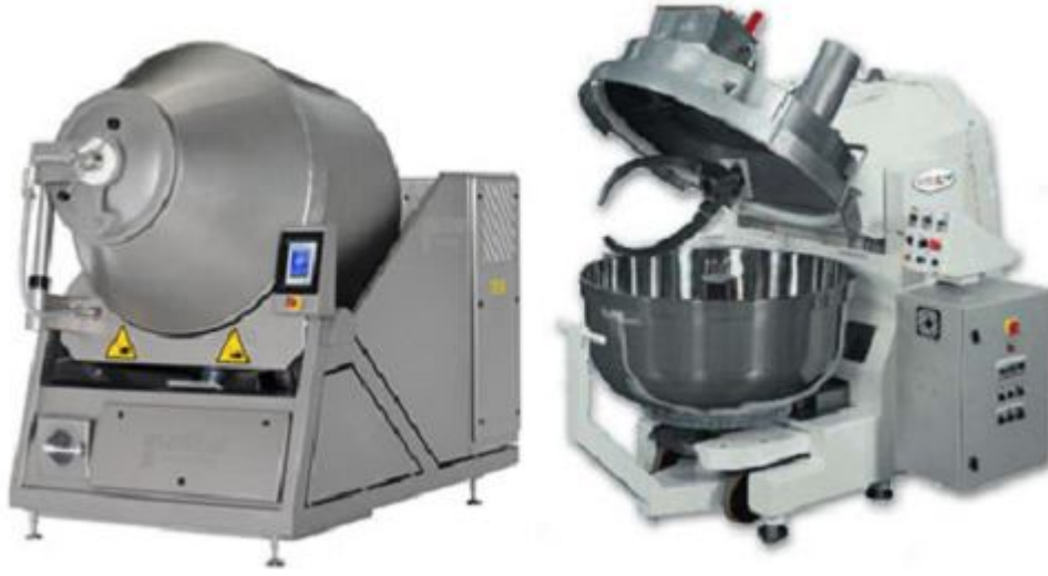
Şekil 4.33 Çeşitli karıştırma tezgahları ve açılır kapanır koruyucu hazneleri
