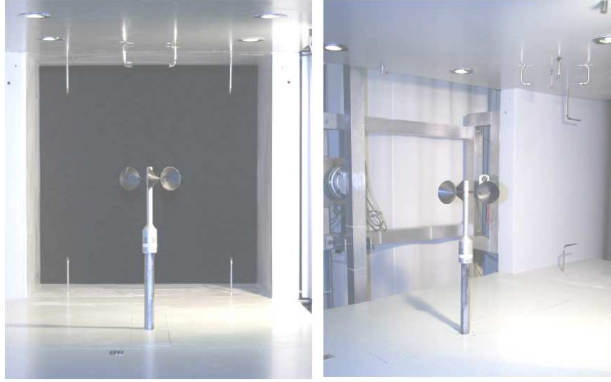
Şekil 6.14 Rüzgâr tüneline anemometre kalibrasyonu (WindGuard GmbH, 2009)
