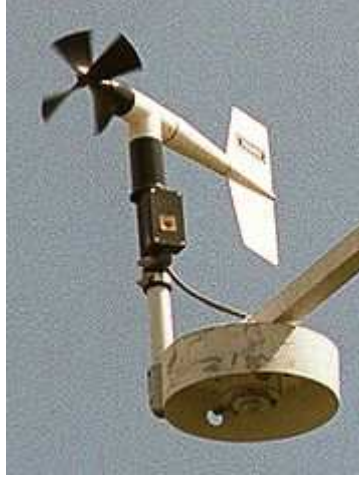
Şekil 6.20 Pervane anemometreli kombine rüzgâr ölçüm sensörü (NRG Systems, 2009)
