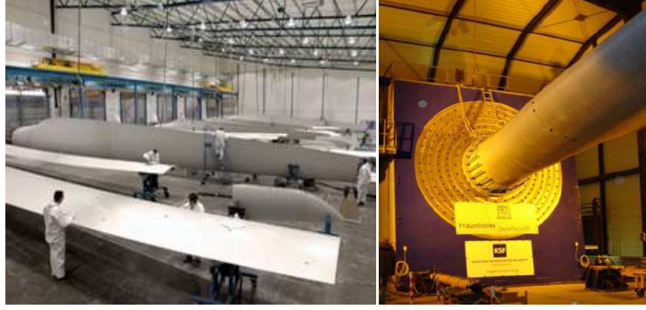
Şekil 4.18 Türbin kanadı üretim süreçleri soldan sağa son işlemler ve statik testler (Özer,2007)
