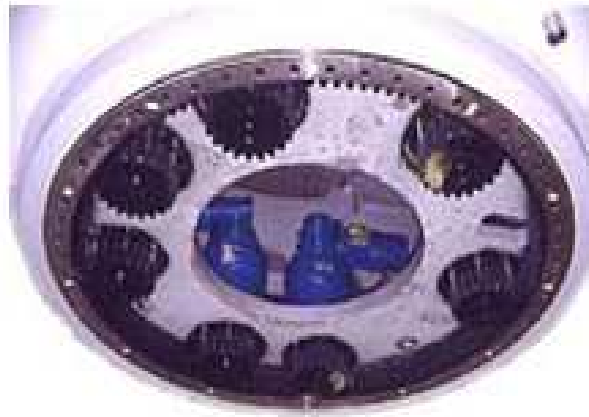
Şekil 3.8 Yaw (sapma) mekanizması (Vestas, 2009)
