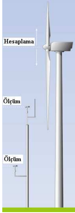
Şekil 6.4 Farklı yüksekliklerde ölçülen rüzgâr hızlarından istenilen bir yükseklikteki rüzgâr hızının hesaplanması
