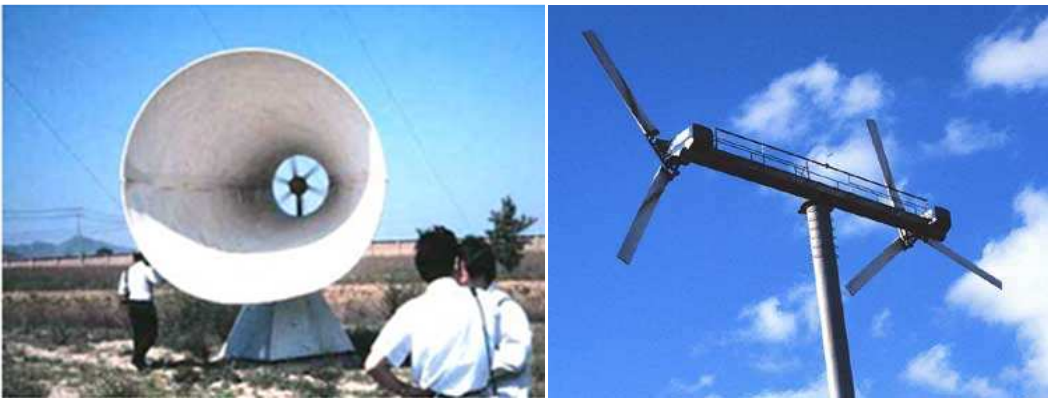
Şekil 3.14 Soldan sağa "Great Diffuser" tipi rüzgâr türbini, Hollanda'da kurulmuş olan iki rotorlu rüzgâr türbini
