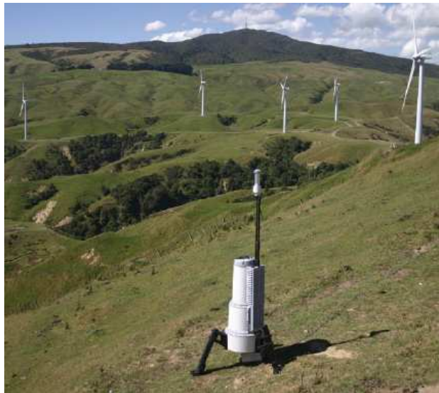
Şekil 6.19 LIDAR sistemi ile rüzgâr santralinin izleme amaçlı rüzgâr ölçümü (Harris ve Locker, 2007)
