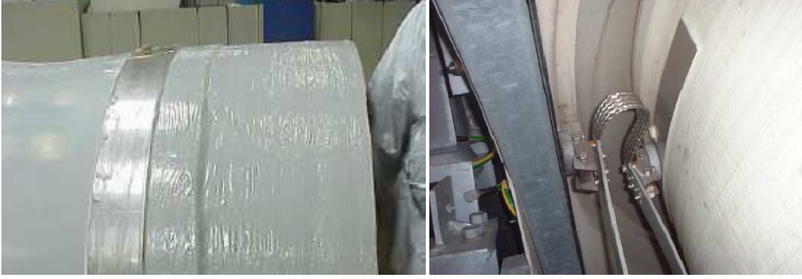
Şekil 4.21 Soldan sağa kanat kökündeki çelik bant, nasel şasisi ile kanat kökü arasındaki yıldırım transfer ünitesi (Vestas, 2009)
