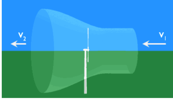
Şekil 5.5 Rüzgâr kesitinin türbine giriş ve çıkıştaki şekli (Danish Wind Industry Association, 2009)
