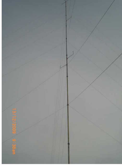
Şekil 7.9 Proje sahasında kurulmuş olan rüzgâr ölçüm verilerinin alındığı ölçüm direği
