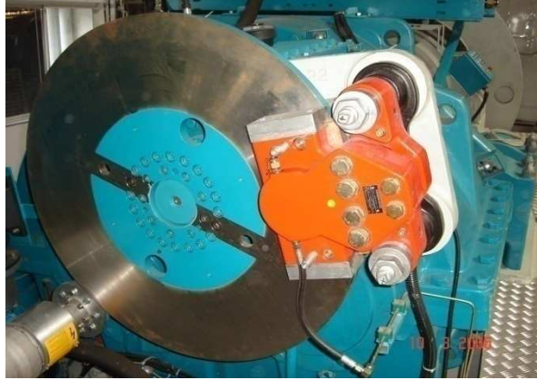
Şekil 4.23 Mekanik Fren Sistemi (Suzlon, 2009)
