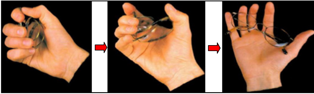
Şekil 2.10 NiTi’den yapılmış bir gözlük çerçevesi ve süper elastiklik özelliği.
