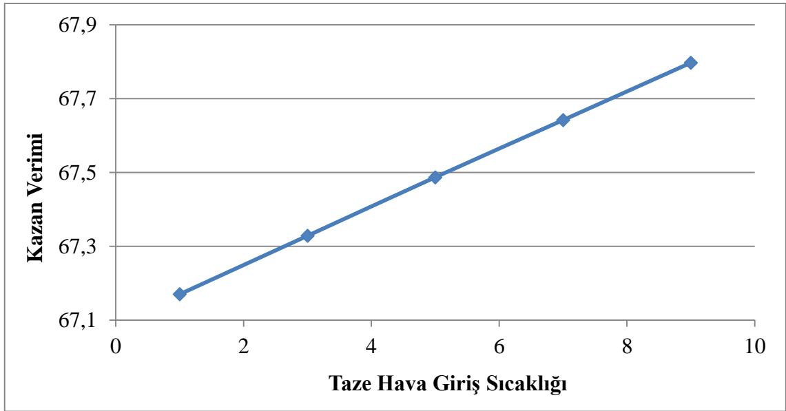
Şekil 9.18 Taze hava giriş sıcaklığı i le kazan verimi arasındaki ilişkisi
