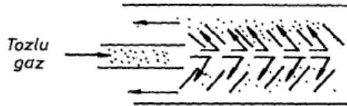
Şekil 8.4 Bir atalet ayırıcının çalışma prensibi [5]
