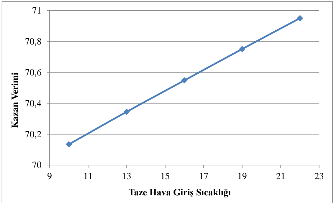
Şekil 9.10 Taze hava giriş sıcaklığı ile kazan verimi arasındaki ilişkisi
