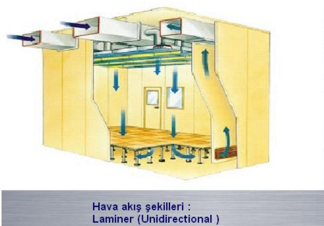
Şekil 2. 5 Laminer Akım Akış Şekilleri
