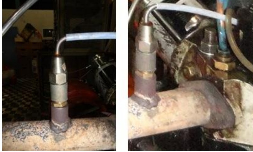
Şekil 4.22 Egzoz manifolduna konumlandırılmış termokupl
