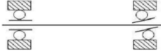
Şekil 2.11 İç bilezik eğilmesi [13]
