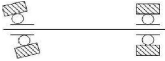
Şekil 2.10 Dış bilezik eğilmesi [13]
