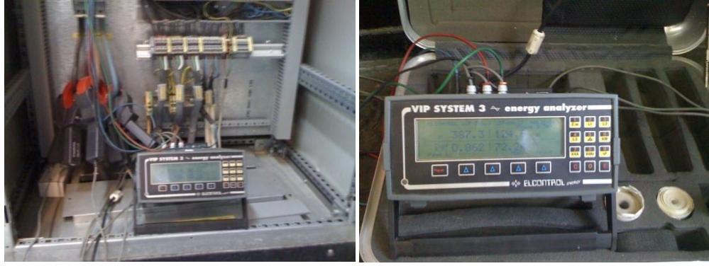
Şekil 7.5 Elektriksel güç ölçümlerinde kullanılan analizör
