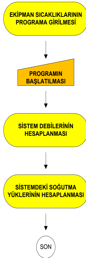
Şekil EK-G.1 Yaz konumu enerji modeli akış diyagramı
