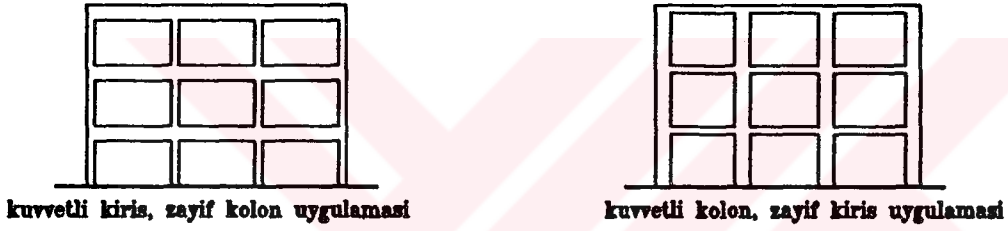
şekil 2.52.. Yapı yüksekliği boyunca zayıf kolon, kuvvetli kiriş yerine, kuvvetli kolon, zayıf kiriş sistemine tercih edilmelidir.
