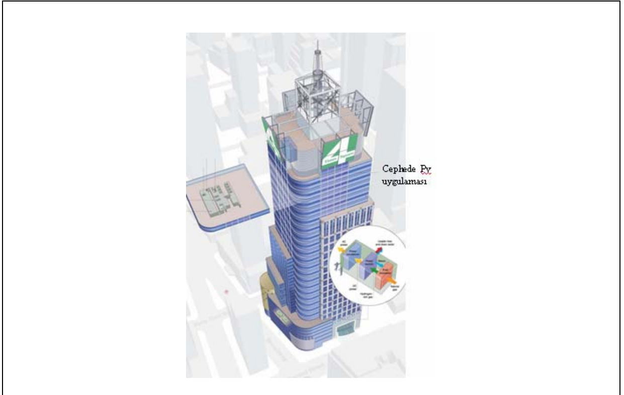
Şekil 4. 6 Cephede Pv uygulaması [15]
