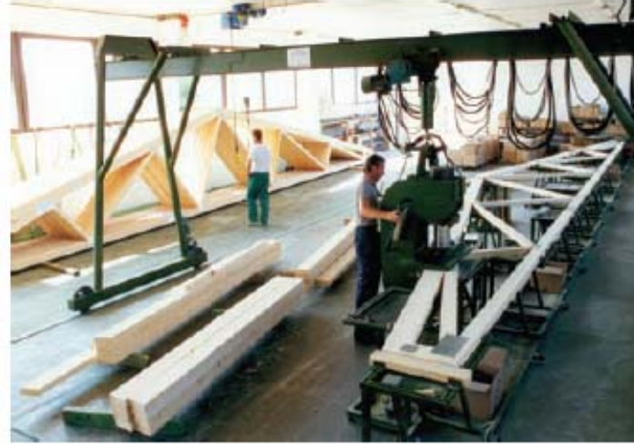
Resim 3.2 Ahşap makas elemanların metal plakalar ile birleştirilmesi [11]
