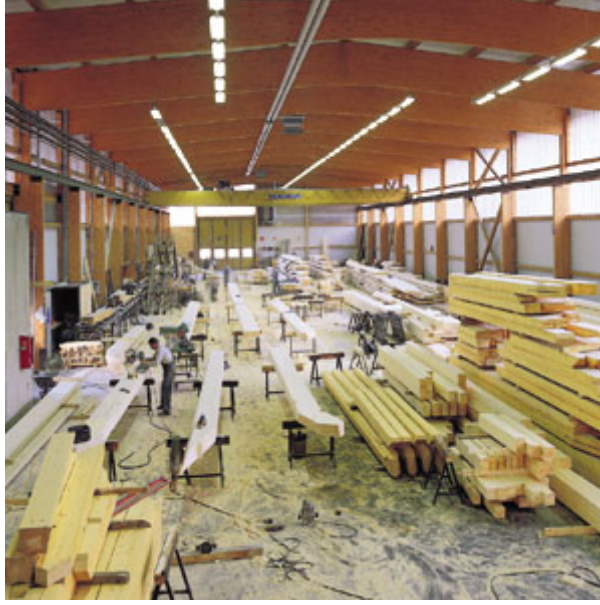
Resim 3.4 Ahşap makas üretiminin yapıldığı atölye [19]
