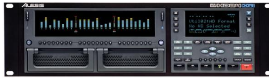
Şekil 4.29 Alesis ADAT-HD24XR sabit diskli çoklu kanal kaydedici (24-bit/96kHz)
