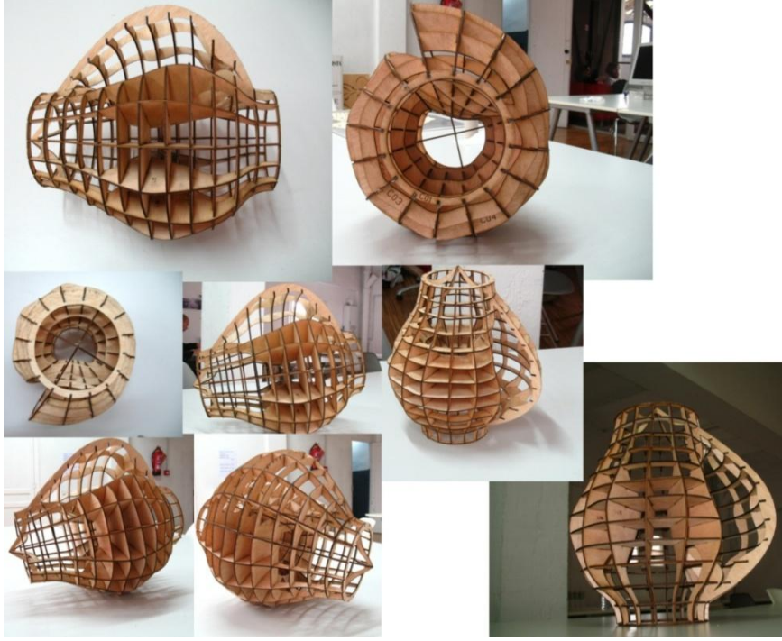
Şekil 4.2 Lazer kesici ile iki boyuttan üç boyuta oluşturulmuş bir dijital üretim örneği [9]
