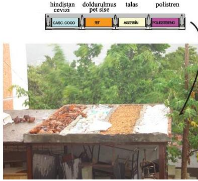
Şekil 3.96 Hazırlanan Yalıtım Testi (Bozza, 2009)
