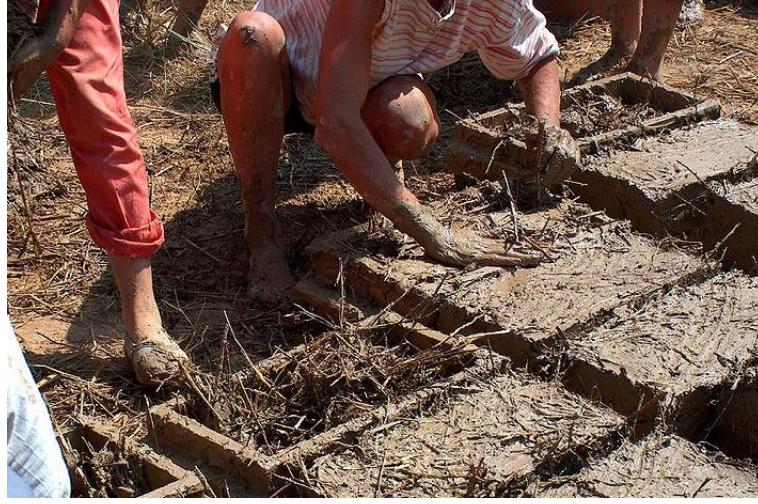
Şekil 3.75 Kerpiç Tuğlaların Hazırlanışı [128]
