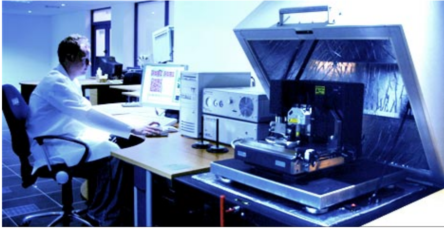
Şekil 3. 3 Atomik Kuvvet Mikroskobu
