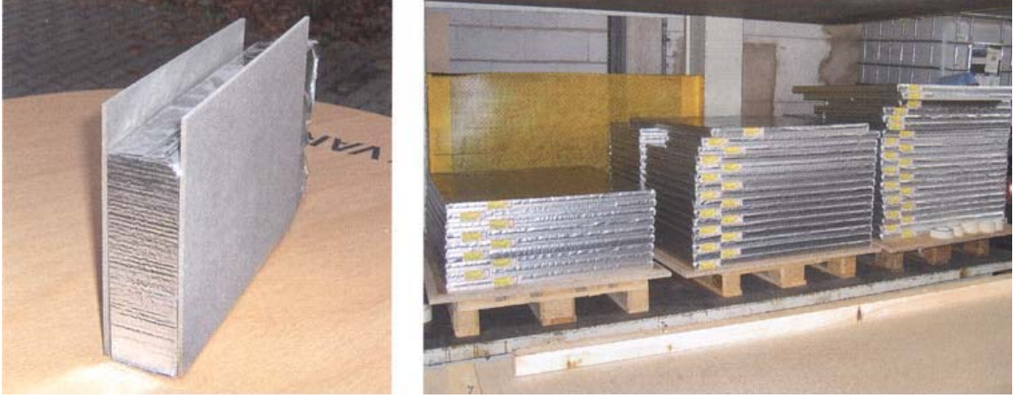
Şekil 3. 19 Isı yalıtım malzemesi: VIPs (Leydecker [19])
