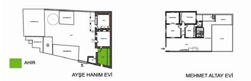
Şekil 6.16 Ahırın günümüzde mekan organizasyonuna dahil edilmemesi
