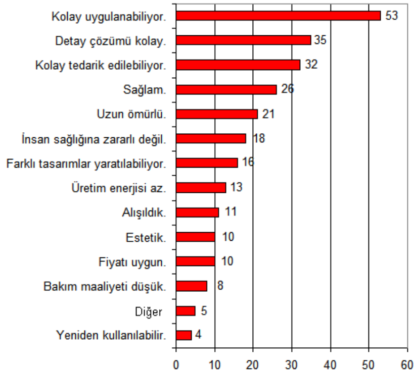
Şekil 3.10 Dış duvarlarda gazbeton kullananların ürünü seçim nedeni
