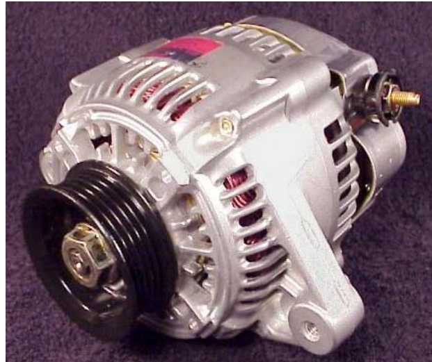
Şekil 7.13 Araçta elektrik enerjisi üreten alternatörün şekli ( http://www.obitet.gazi.edu.tr/sunu.htm/alternator , 2007)
