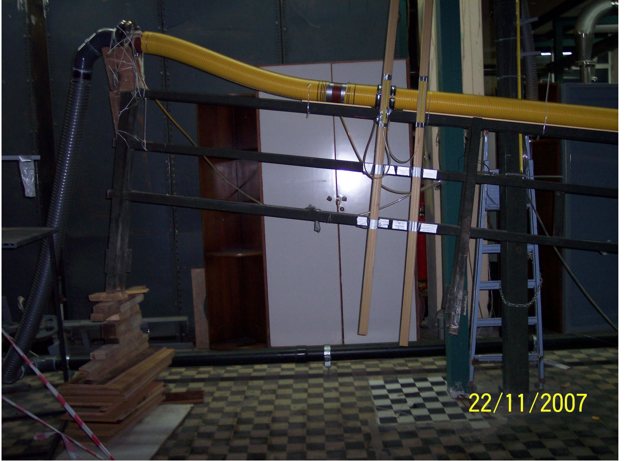
Şekil 4.11 Açık kanal akımı deney tesisatı resmi
