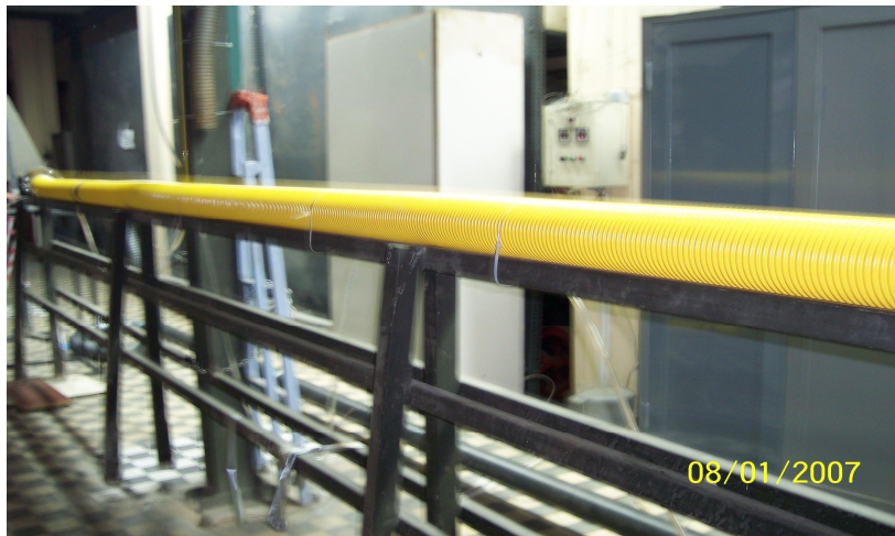
Şekil 4.5 Ondüleli borunun deney tesisatında görünümü
