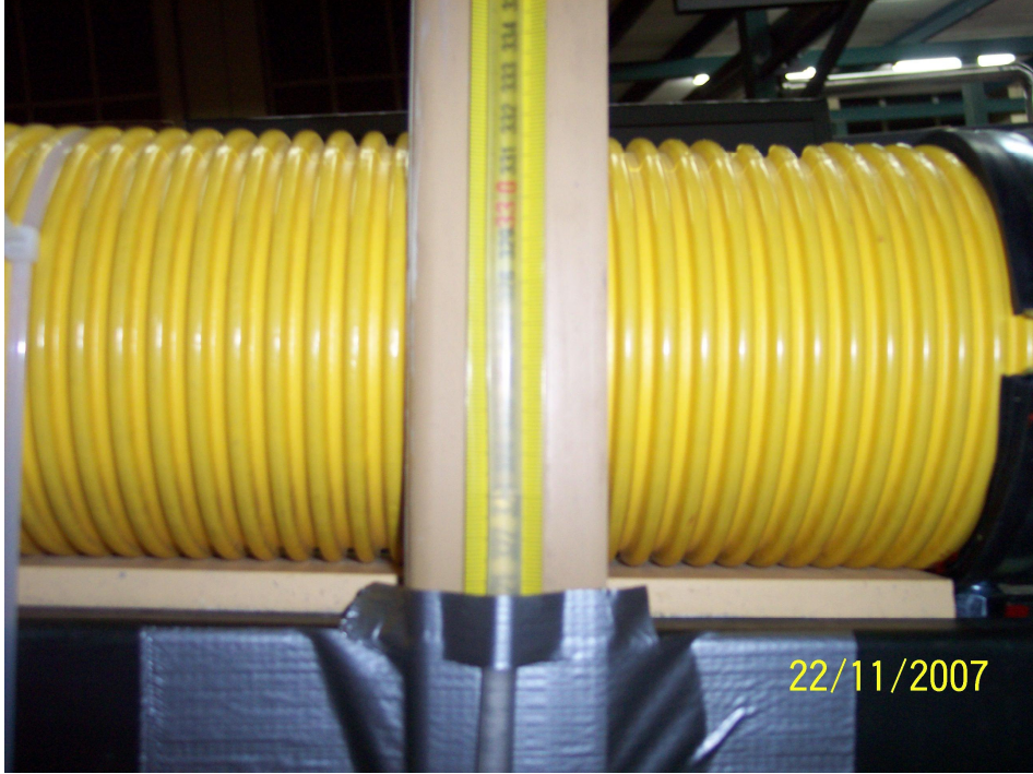
Şekil 4.12 Su seviye yüksekliği ölçüm istasyonu
