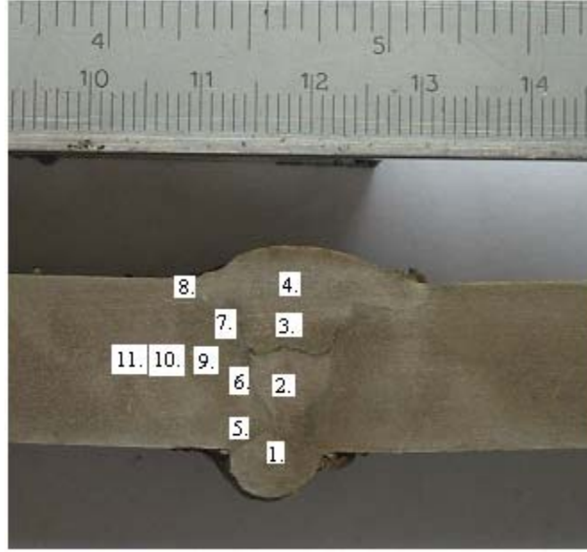
Şekil 6.8 45° V Kaynak ağzına sahip St37 numunede sertlik taraması yapılan bölgeler.
