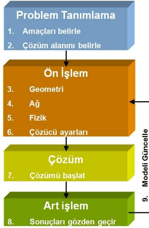
Şekil 5. 8 CFD modellemede işlem adımları [40]
