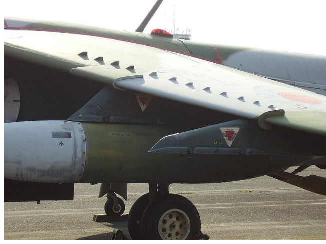
Şekil 5. 46 Bir savaş uçağı kanadı üzerine yerleştirilmiş vorteks generatörleri [45]
