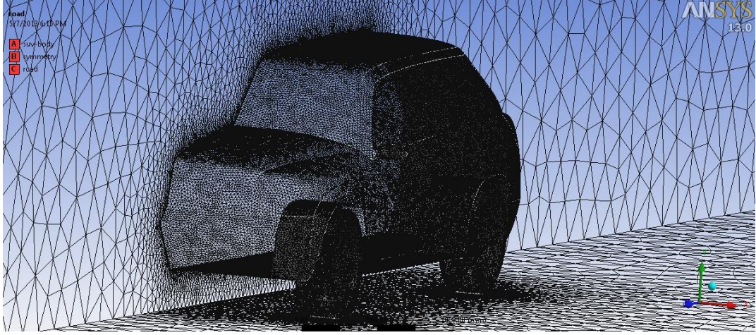
Şekil 5. 11 Taşıt yüzeyinde oluşturulan ağ yapısı (ön görünüm)
