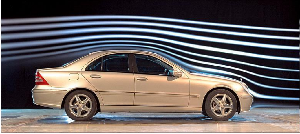
Şekil 3. 2 Taşıt gövdesi üzerinde akmakta olan akış tüpleri [20]
