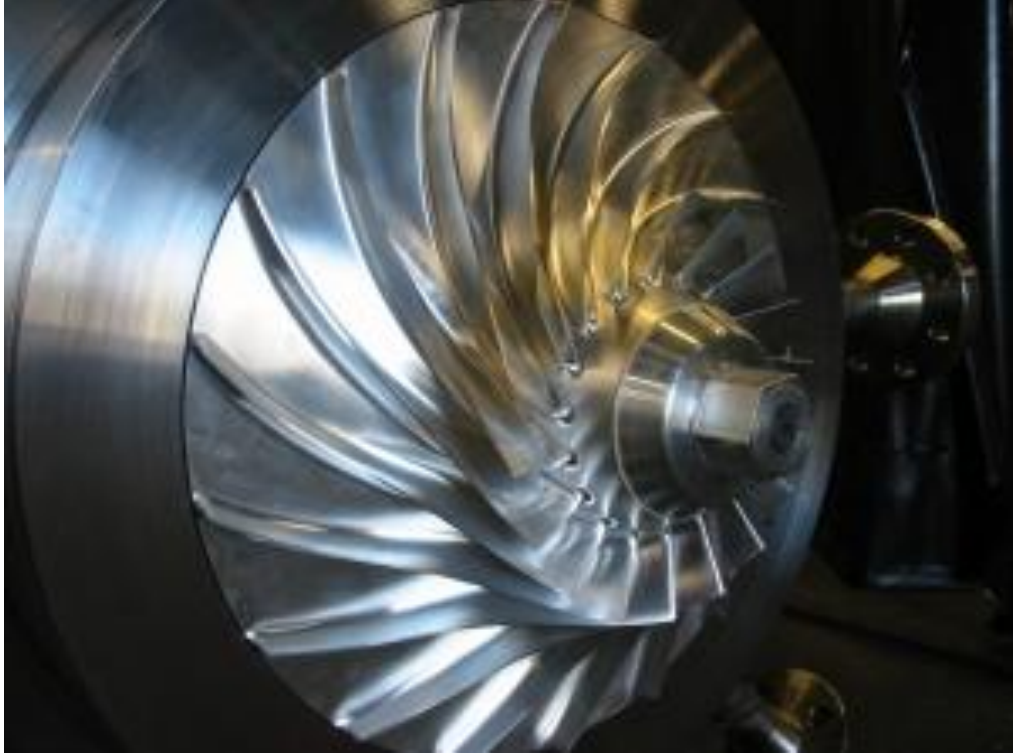
Şekil 4.10 Açık tip türbin çarkı [28]
