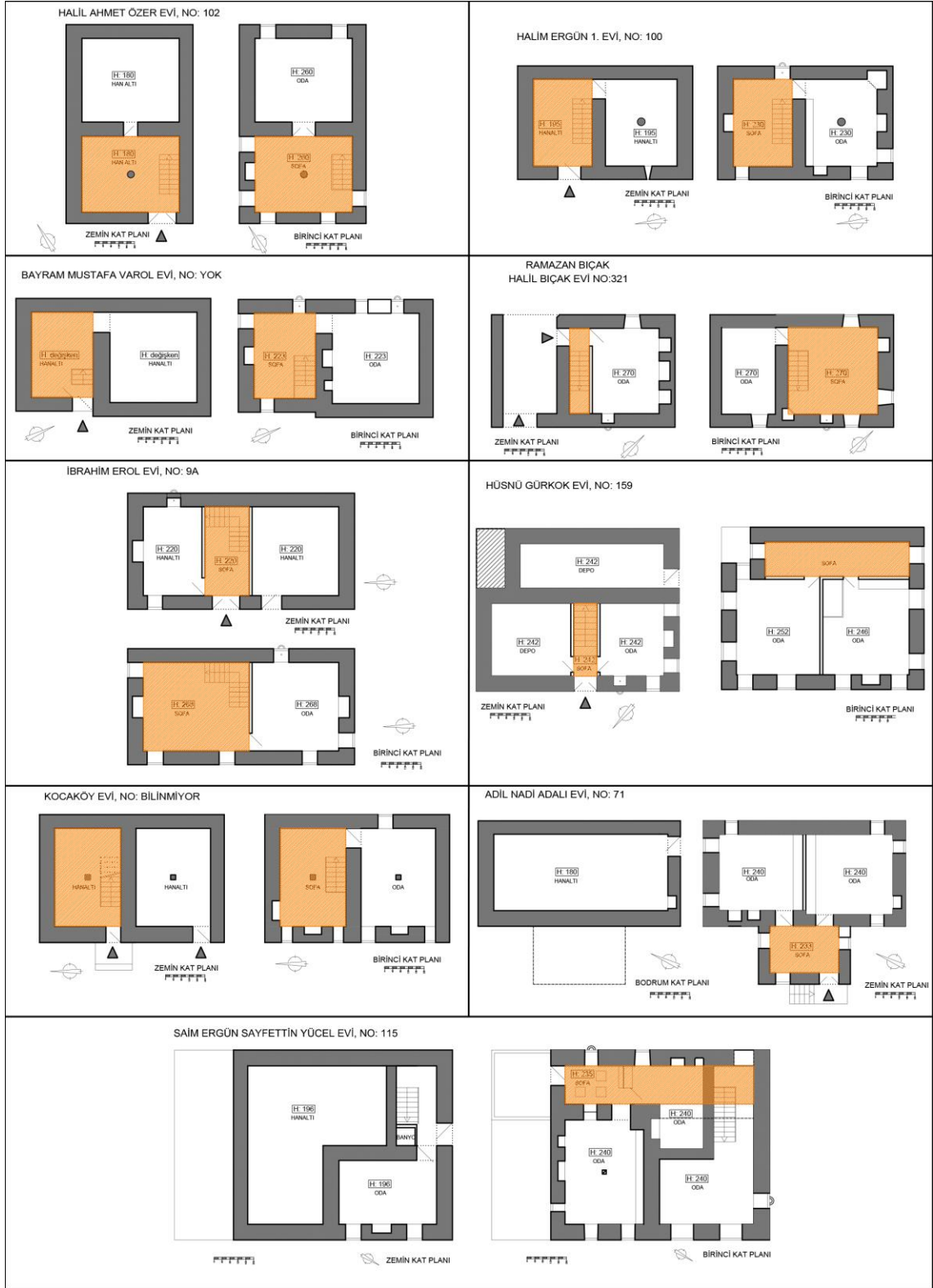
Şekil 3.262 Yan sofalı iç merdivenli yapı örnekleri
