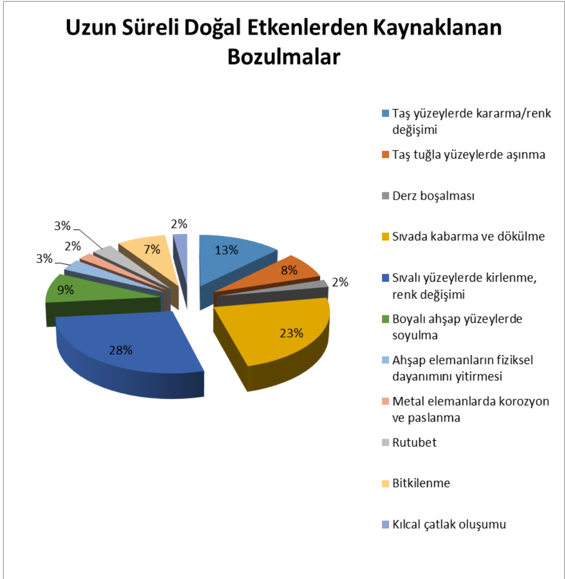
Şekil 4. 9 Uzun süreli doğal etkenlerden kaynaklanan bozulmaların yapılardaki dağılımı
