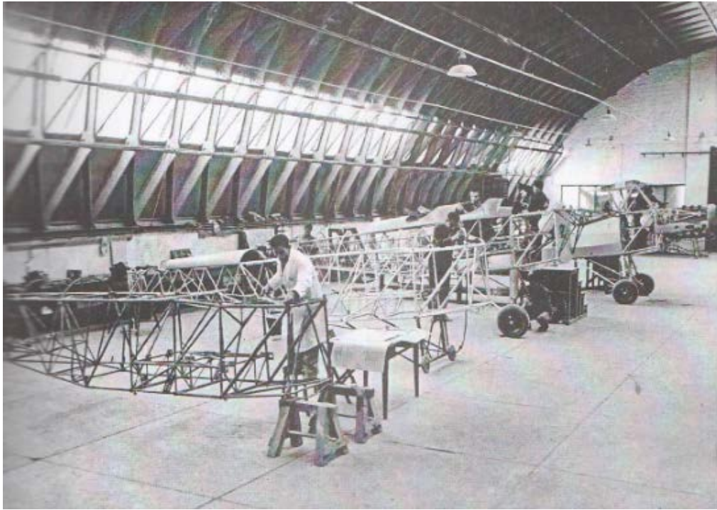
Şekil 4.103 Gotha GO-145A Tayyaresi, Montaj Atölyesi [138]
