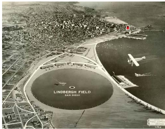
Şekil 2.115 The Lindbergh Uçuş Alanı, San Diego, Cal., 1927, ABD. 500 m yarıçaplı dairesel alan, deniz-uçağı barınağının/hangarların bitişiğinde konumlanmıştır [157]
