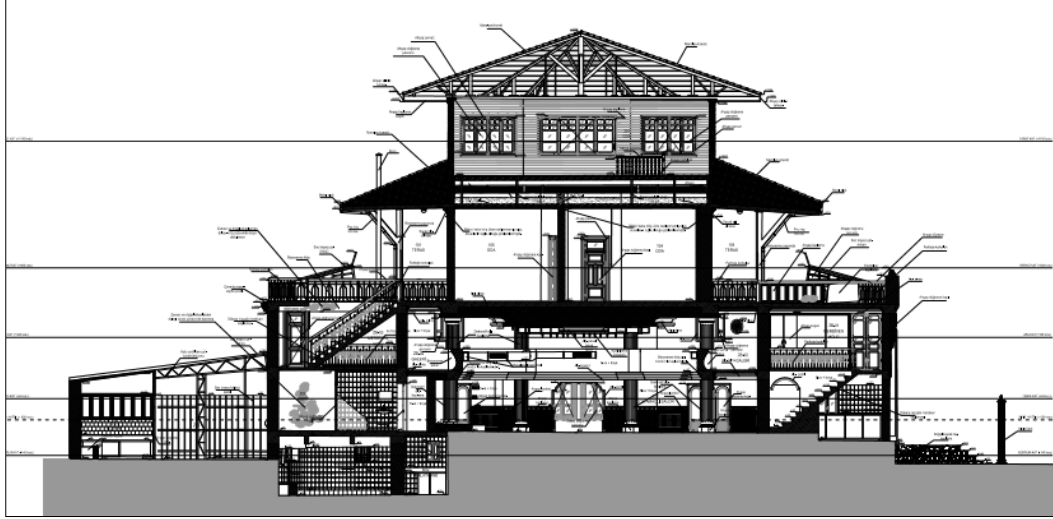
Şekil 4.56 THK, "Ödemiş Tayyare Binası", rölöve projesi, A-A kesiti, ölçek:1/50, Ödemiş, İzmir [262]
