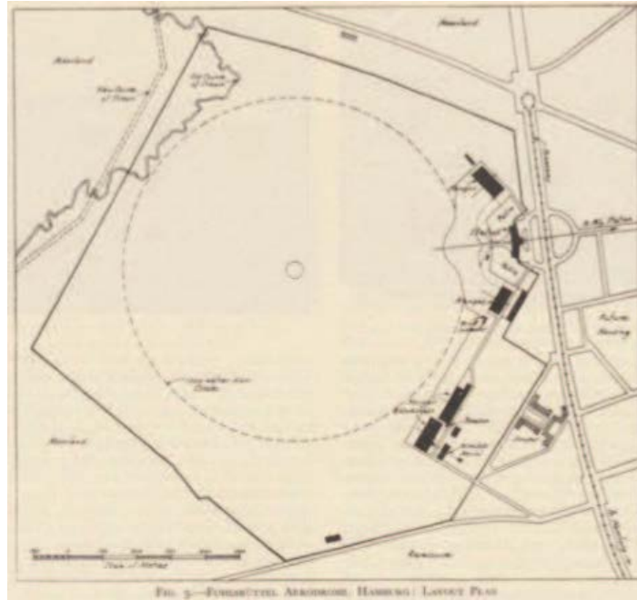
Şekil 2.123 Hamburg Fulsbüttel Havaalanı (The Hamburg-Fulsbüttel Aerodrome) haritası, 1929. Mimarlar: Dyrssen&Averhoff. İstasyon binası ve çevresindeki hangarlar, hafif raylı sistem hattı ile karatarafı yaklaşık plaza ile komşuydu ve istasyon binasının her iki tarafındaki iki çitle çevrili seyirci alanları bulunuyordu [157]
