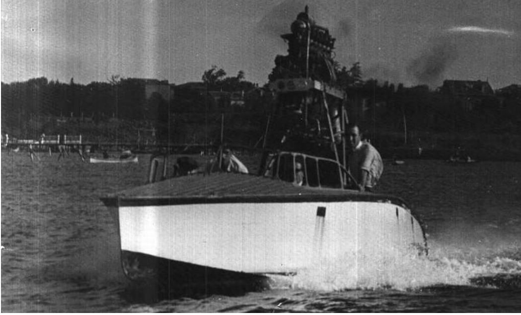
Şekil 4.231 Hürkuş uçak motoru kullanılarak Vecihi SK-X adlı bir su kızıağı da yapılmıştır, 1933 [191]
