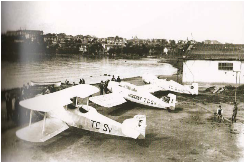
Şekil 4.225 Vecihi Hürkuş'un Nuri Demirağ için yaptığı Vecihi-XVI tipi uçak (ortadaki kapalı-kabin tasarımlı ilk uçak), Kadıköy, İstanbul [324]
