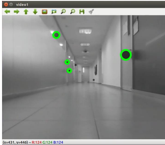
Şekil 5. 6 Drone kalkış anında tespit edilen daireler
