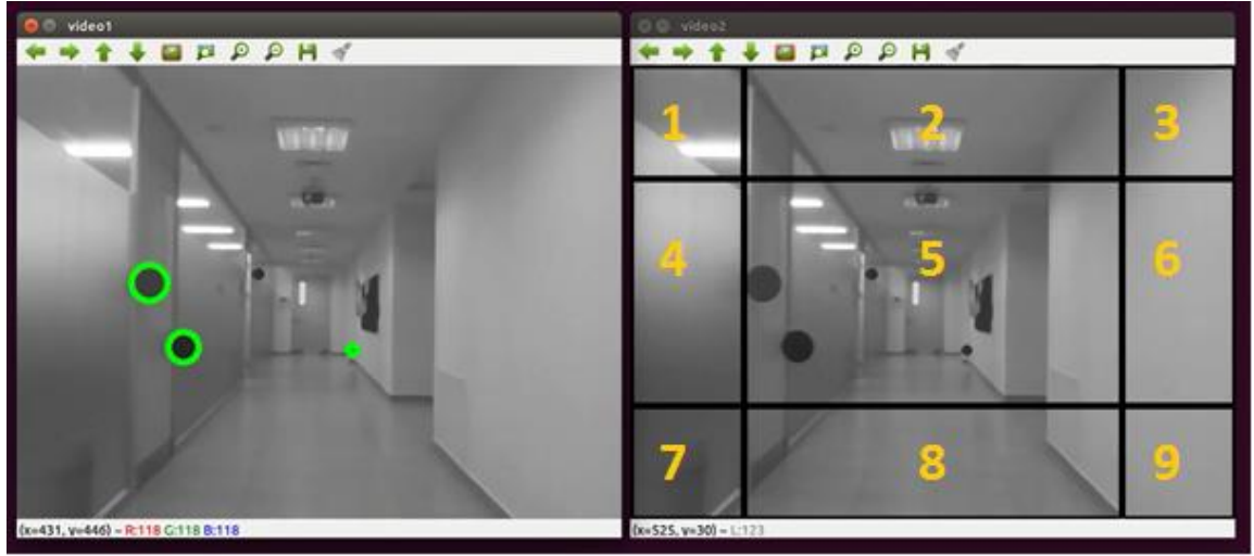
Şekil 6. 3 Uçuş anında dairesel cisimlerin yakalanması ve aracın yönlendirilmesi
