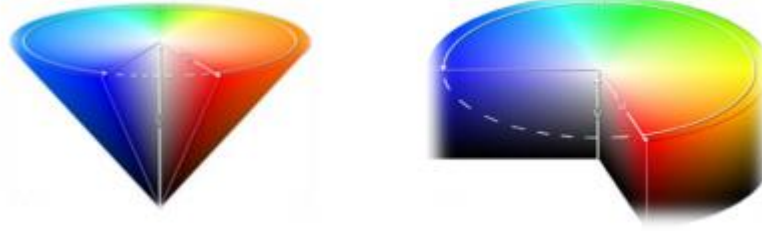
Şekil 5. 1 HSV renk uzayının konik ve silindirik görünüşleri
