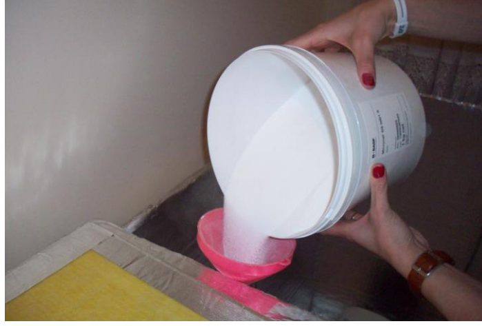
Şekil 3.17 Şeffaf akrilik kaba Faz Değiştiren Maddenin yerleştirilmesi
