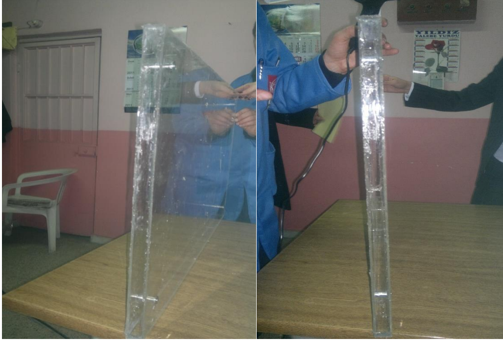
Şekil 3.6 Şeffaf akrilik kabın montajı (kesilen malzemenin silikon ile birleştirilmesi)
