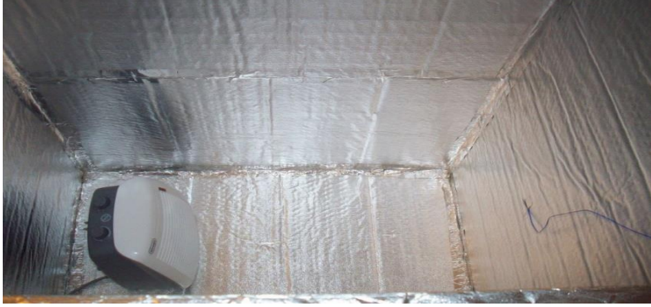
Şekil 3.20 Dış ortam olarak kabul edilen oda duvar yüzeyine K Tipi probun ve fanın yerleştirilmesi
