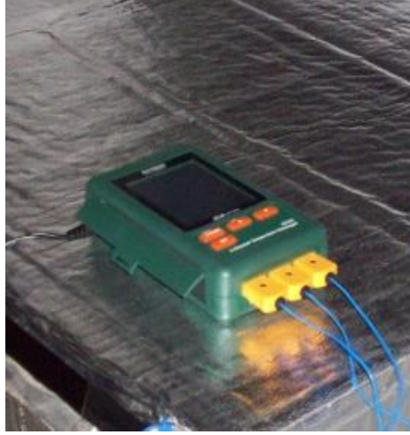
Şekil 3.8 SD 200 Üç Kanallı Sıcaklık Kayıt Cihazı
