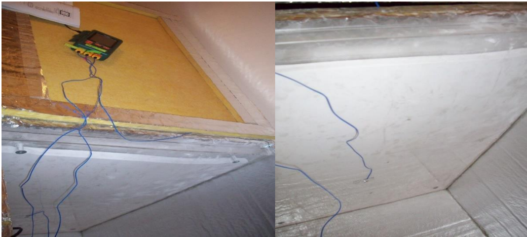
Şekil 3.22 Faz değıştiren madde yüzeyine K Tipi probun yerleştirilmesi
