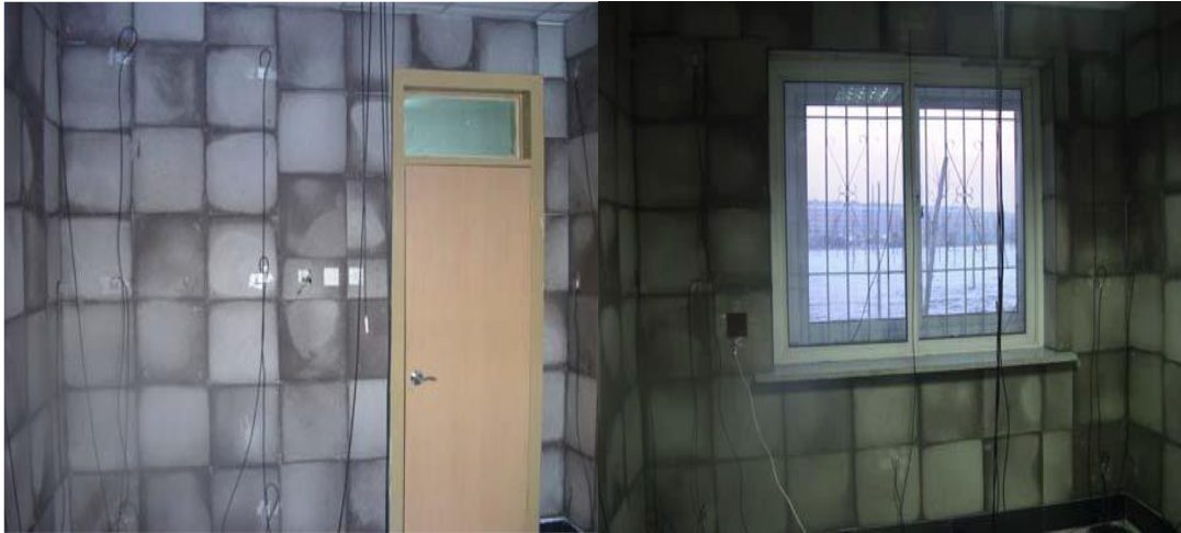
Şekil 2.4 FDM’li Deney Odası[36]
