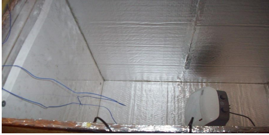
Şekil 3.21 İç ortam olarak kabul edilen oda duvar yüzeyine K Tipi probun ve fanın yerleştirilmesi
