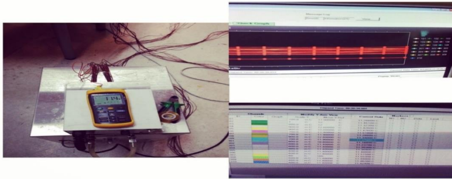
Şekil 5.4 Kalibrasyon su banyosu, referans termometre, Benchlink programı
