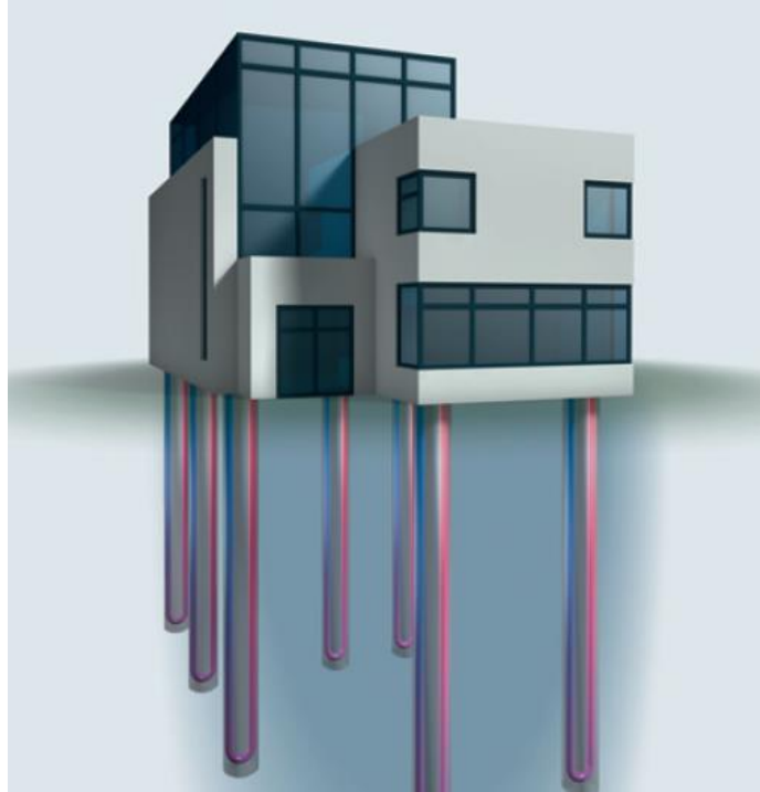
řekil 2.8 Enerji kazıkları uygulamasının řematik grnm [7]
