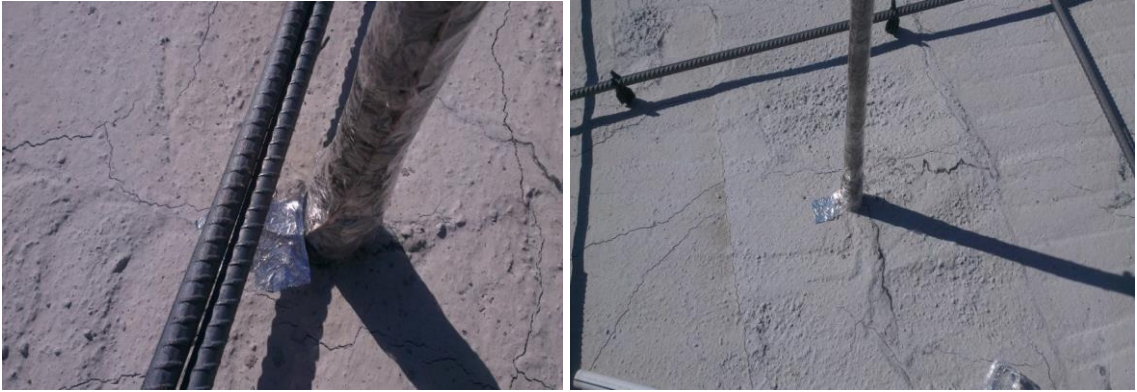
Şekil 5. 11 Toprak hattına ait ısıl çift yerleşimi
