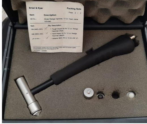
Şekil 3.16 Darbe çekici ve tek eksenli ivmeölçer
