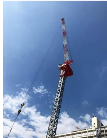
Şekil 4.2 Farklı kafes tiplerine sahip mast örnekleri
