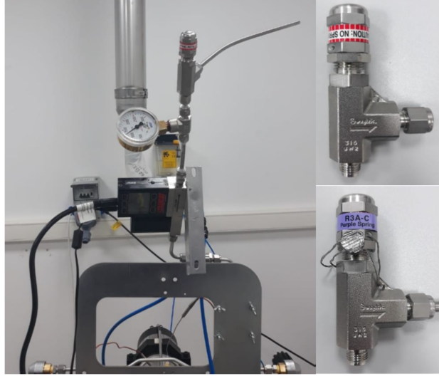
Şekil 5.10 Basınç emniyet valflerinin kalibrasyonu
