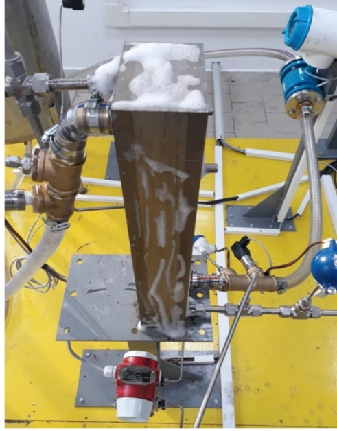
Şekil 5.16 PCHE kabarcık testi
