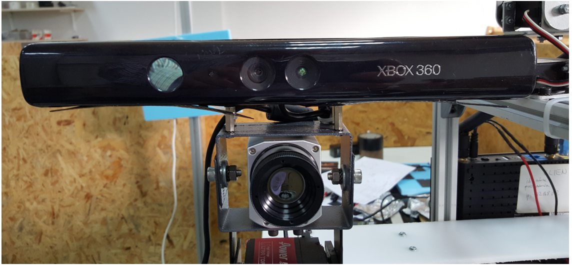
Şekil 3.14 Termal kamera ve Kinect için bağlantı düzeneği
