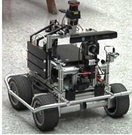
Şekil 2.1 2015 Robocup Rescue German Open yarışmasında Yıldız Teknik Üniversitesi Olasılıksal Robotik Grubu tarafından kullanılan robot
