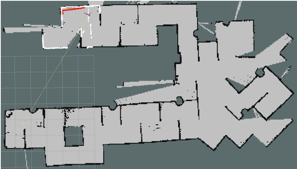
Şekil 2.2 2015 Robocup Rescue German Open yarışma alanının Hector haritalaması ile lazer verisi kullanılarak çıkarılan 2 boyutlu haritası
